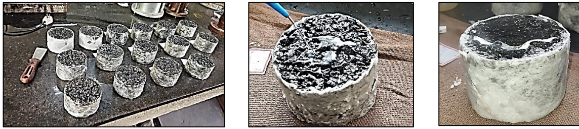
Figura 26 - Corpos de prova submetidos ao ensaio de vazios comunicantes
