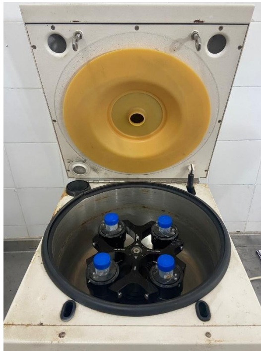
Figura 30 - Nanopartículas dissolvidas em álcool etílico em centrífuga.
