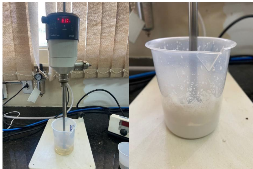
Figura 28 - Agitação mecânica da oleilamina e adição das nanopartículas na proporção de 1:2.
