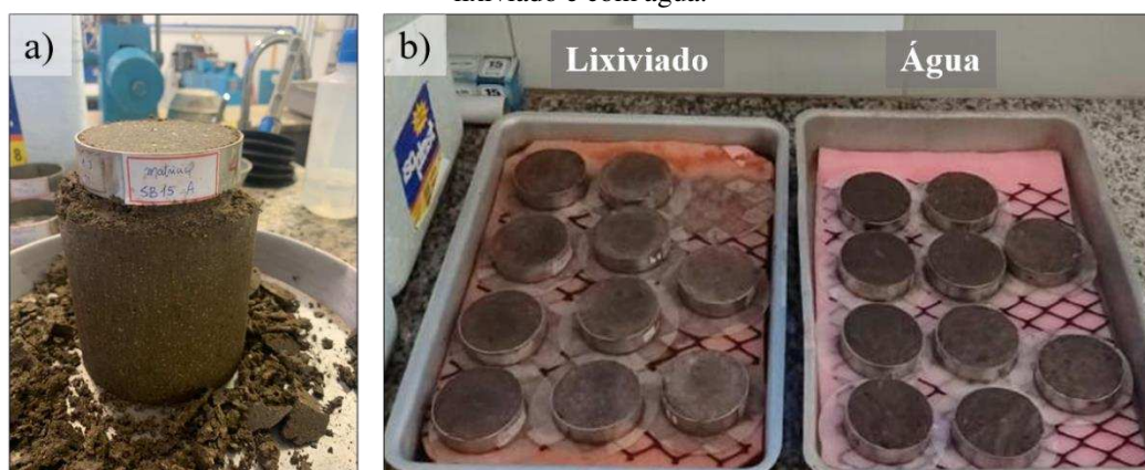
Figura 65 – Corpos de prova de solos utilizados nos ensaios de curva de retenção: a) talhamento de anel cilíndrico em corpo de prova de solo; b) amostras de solos em processo de saturação por capilaridade com lixiviado e com água.
