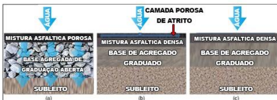
Figura 2 - a) Pavimento drenante; (b) Camada porosa de atrito; (c) Pavimento convencional.
