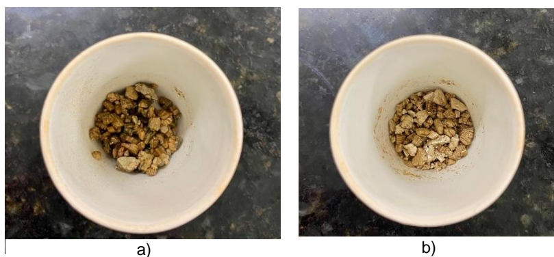
Figura 26 – Amostra submetida ao ensaio de calcinação em mufla, a) antes e, b) após.
