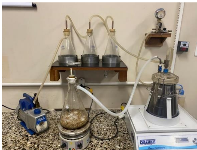
Figura 25 – Processo de saturação da vermiculita expandida
