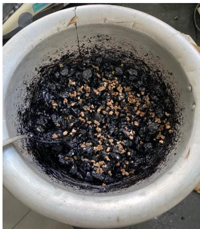
Figura 34 – Adição da vermiculita saturada à mistura asfáltica
