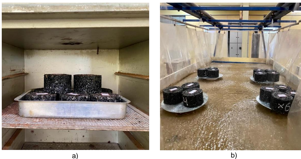
Figura 36 – Protocolo de envelhecimento combinado entre a) estufa convencional e, b) simulador de chuva
