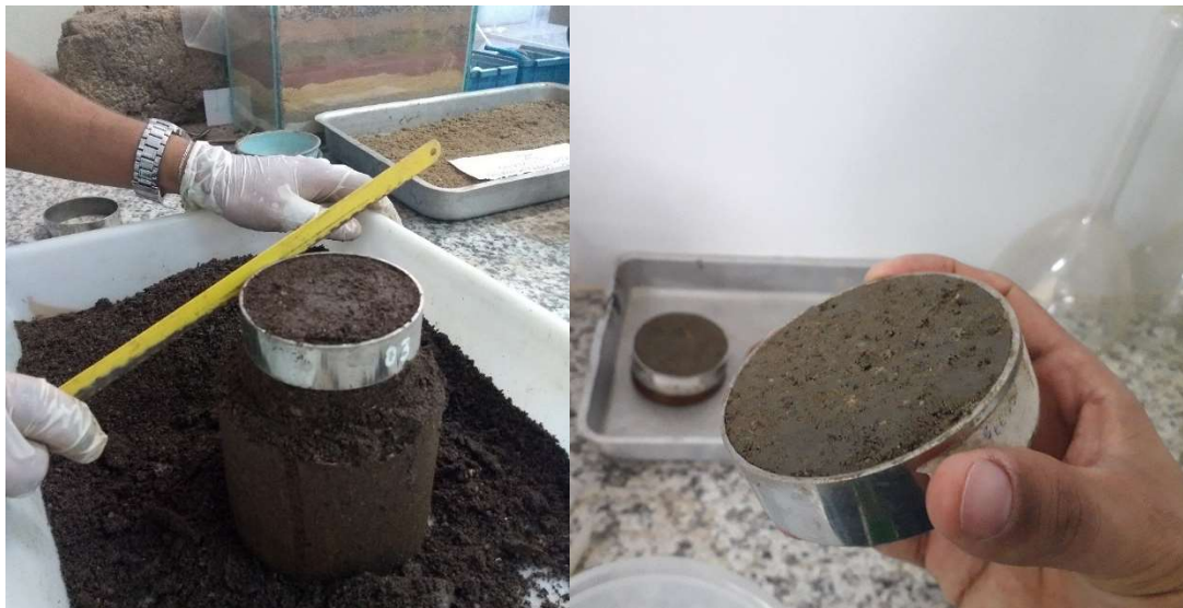
Figura 32 - Confeção de corpos de prova para determinação da sucção por meio do método do papel filtro.
