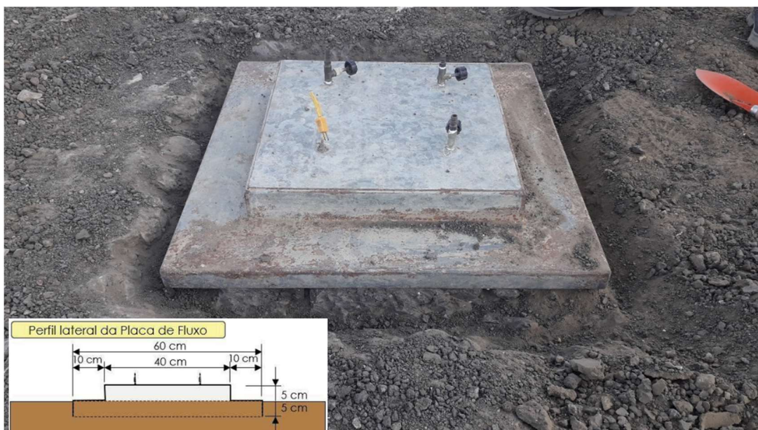
Figura 25 - Placa de fluxo estática cravada no solo.
