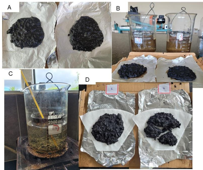
Figura 17: Ensaio de adesividade: (A) Amostras em repouso por 24 horas; (B) Aparatos utilizados no ensaio; (C) Amostra sendo aquecida em chama; (D) Amostra após procedimento de execução do ensaio.
