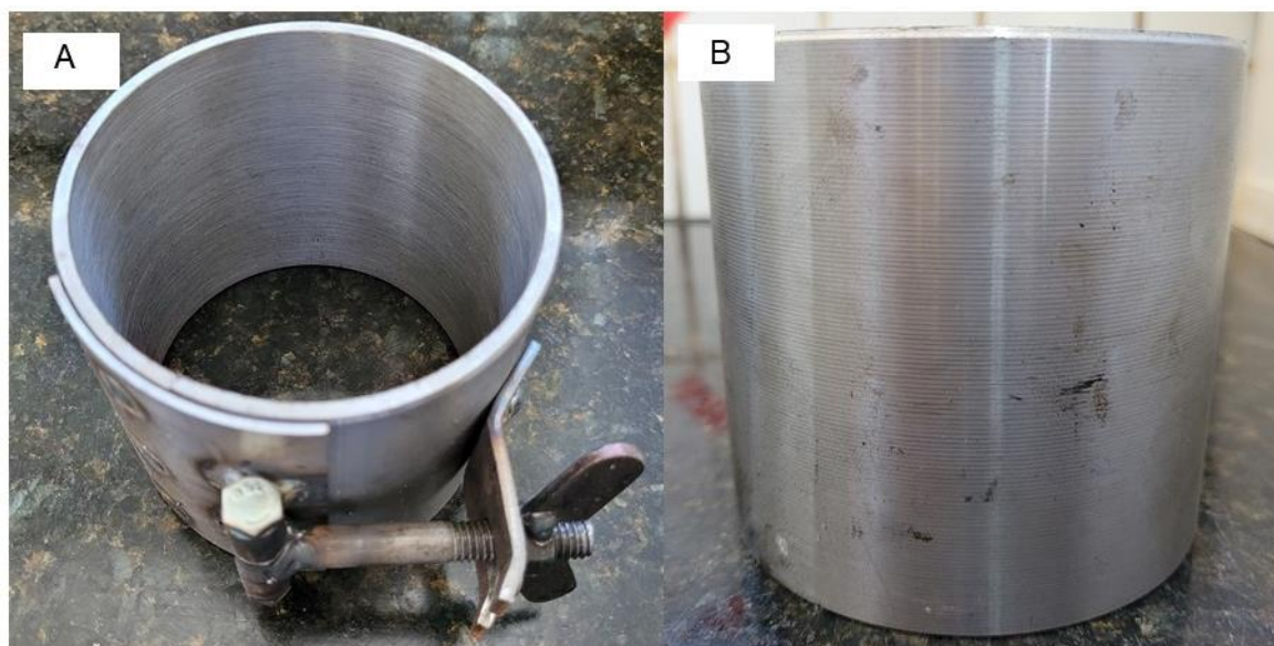
Figura 26: Molde ajustável: (A) vista de cima; (B) vista frontal.
