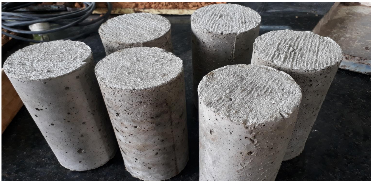
Figura 25: Corpos de prova de concreto de cimento Portland.
