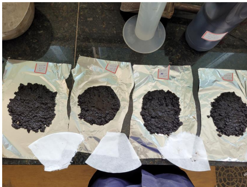
Figura 13: Ensaio de tempo de mistura no MRAF.
