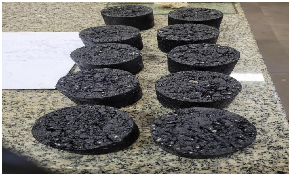
Figura 24: Corpos de prova de concreto asfáltico.
