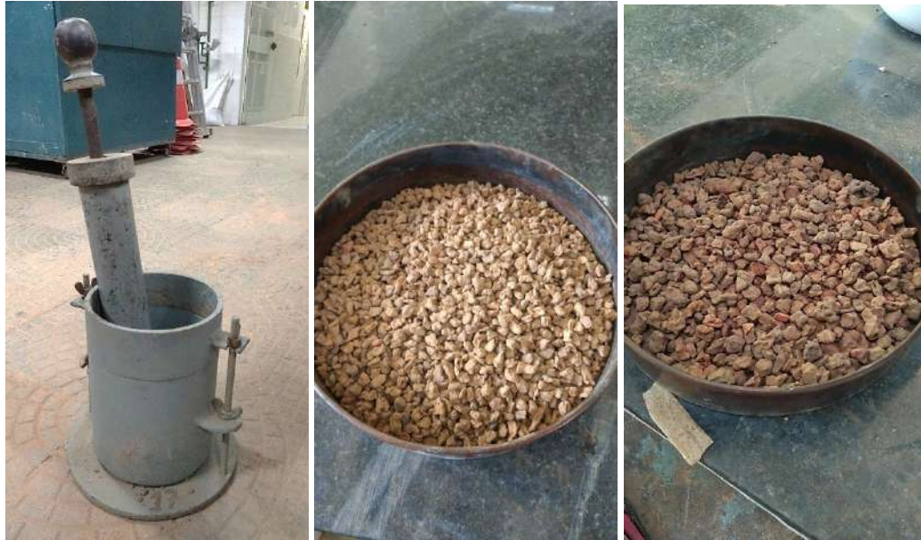
Figura 48: Execução do ensaio de fragmentabilidade
