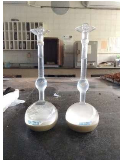
Figura 57: Cimento Portland Pozolânico (CP IV-32) e ensaio de massa específica
