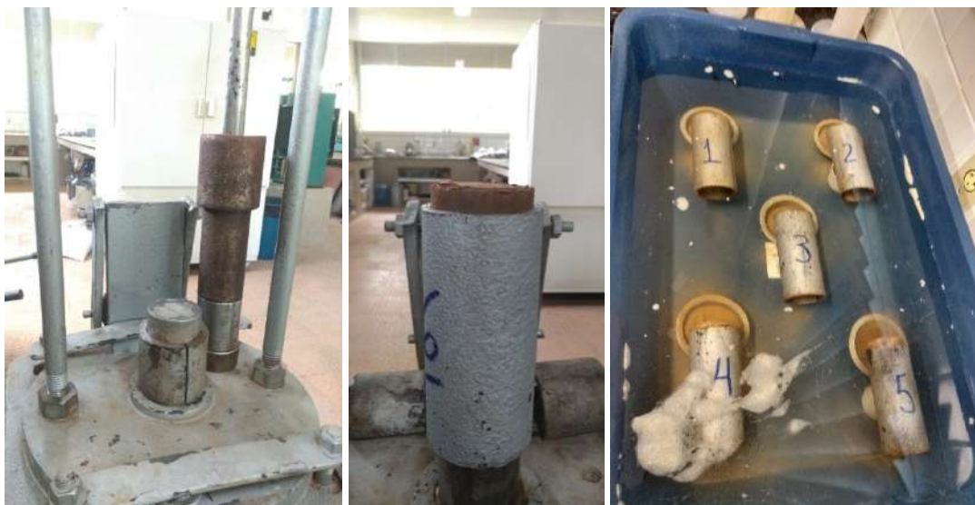
Figura 55: Ensaio para classificação MCT e G-MCT
