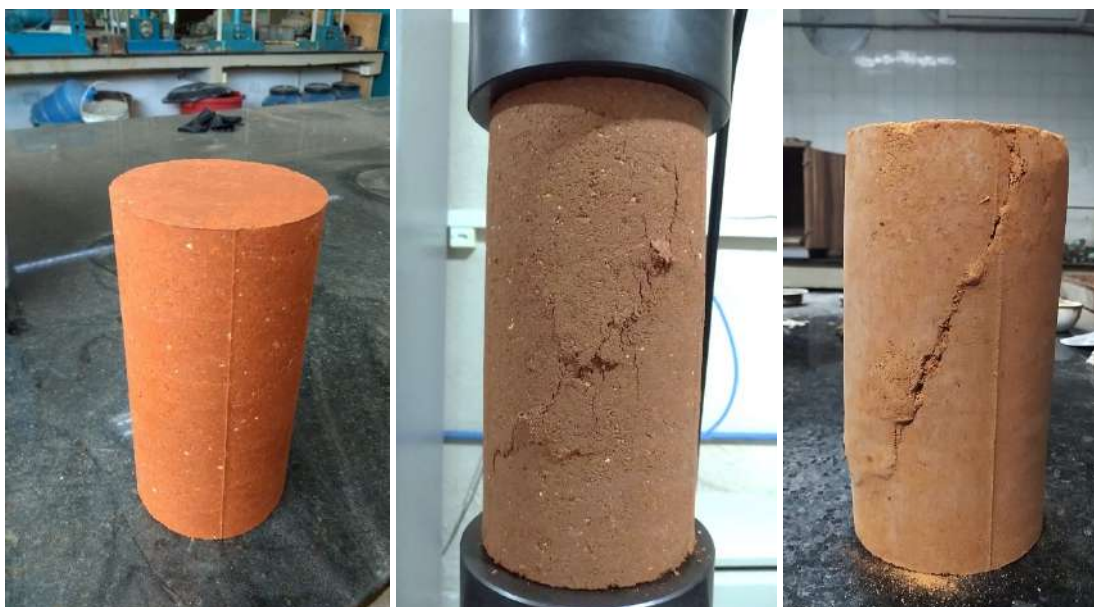
Figura 73: Resistência à compressão simples com deformação controlada
