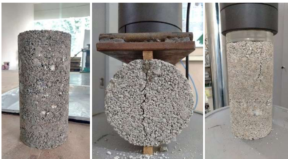
Figura 82: Ensaios com mistura de BGTC
