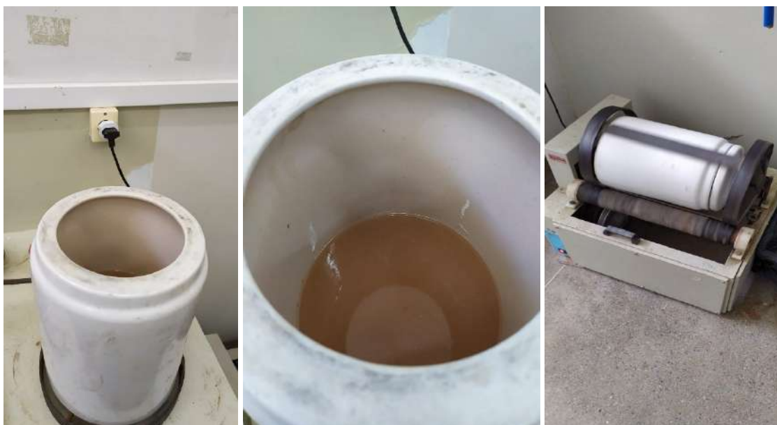
Figura 52: Execução do ensaio de friabilidade das areias
