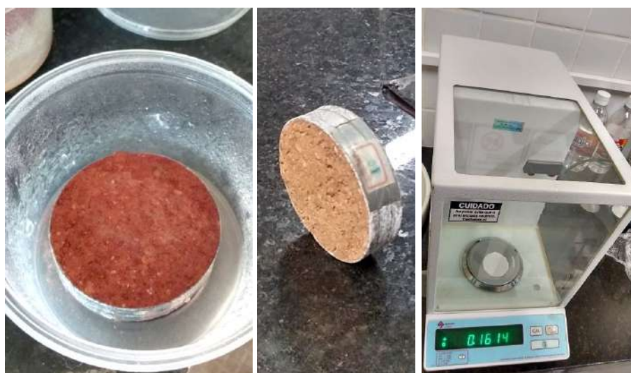
Figura 80: Processo de saturação e secagem dos corpos de prova e pesagem do papel filtro
