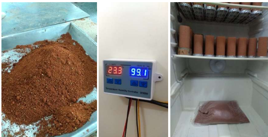
Figura 72: Umedecimento e armazenamento em câmara úmida
