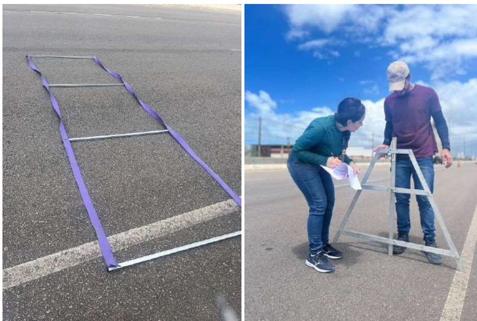
Figura 83: Determinação do percentual de área trincada e do afundamento de trilha de roda
