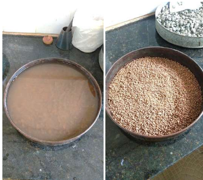
Figura 50: Execução do ensaio de degradabilidade
