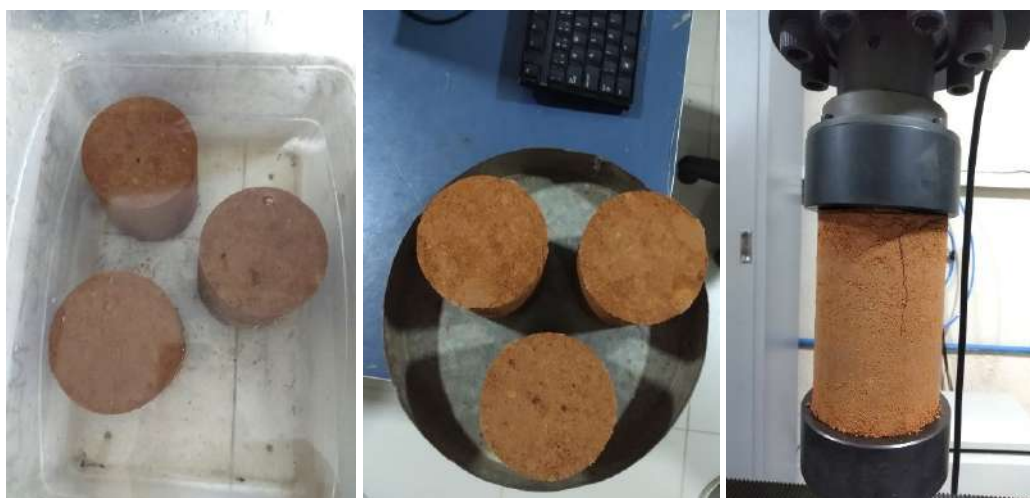
Figura 70: Dosagem do teor de cimento
