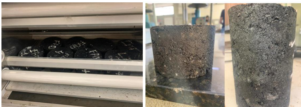
Figura 42- Corpos de prova envelhecidos na câmara UV
