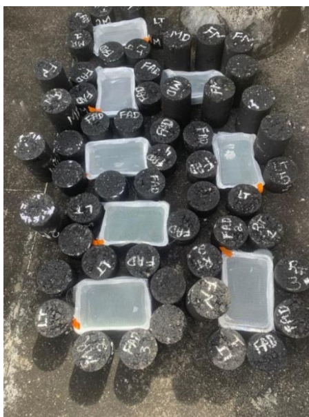
Figura 47- Misturas asfálticas submetidos ao envelhecimento em campo
