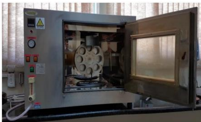
Figura 22 - Equipamento RTFO do Laboratório de Engenharia de Pavimentos (LEP/UFCG)
