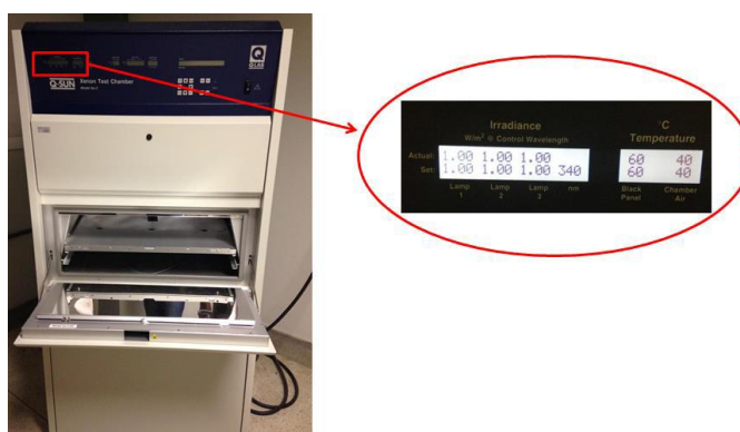
Figura 9 - Imagens da câmara de envelhecimento acelerado (Weatherometer)
