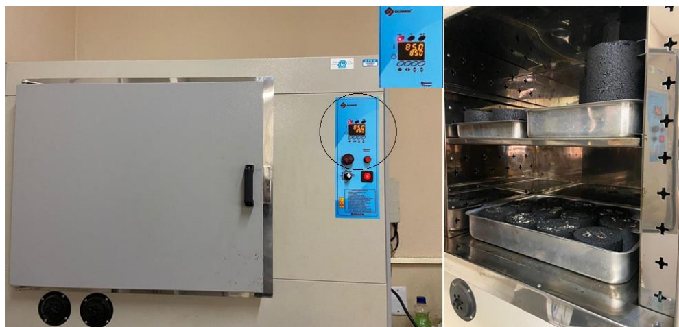
Figura 43 - Corpos de prova em estufa a 85°C por 5 dias para simulação do envelhecimento
