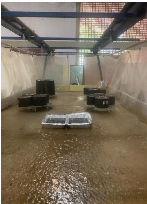
Figura 34 - Amostras de ligantes submetidas a umidade por meio do simulador de chuva
