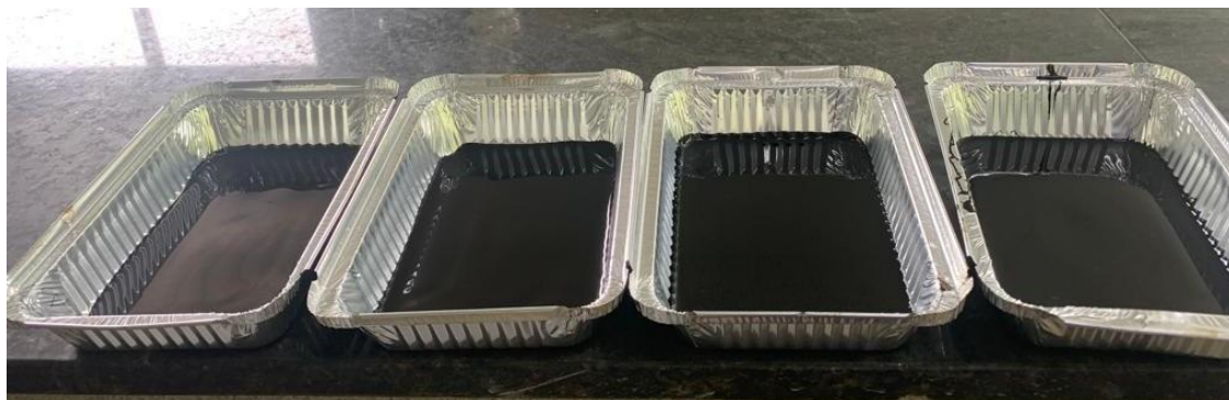
Figura 26 – Amostras de ligantes envelhecidos por radiação UV
