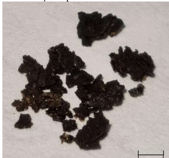
Figura 38 – Nanopartículas após modificação superficial com ácido oleico
