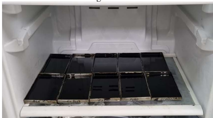
Figura 32 – Amostras de ligante asfáltico dispostas em placas USAT dispostas em ciclo de congelamento
