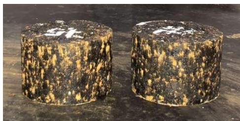
Figura 36 – Corpos de prova com 7,5% de rejeito de minério de ferro compactados com teor ótimo de 5,4% de CAP
