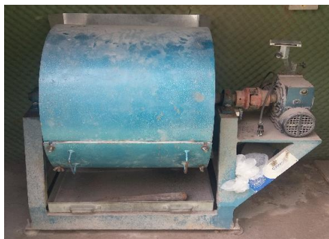
Figura 43 – Equipamento para realização do ensaio de Los Angeles
