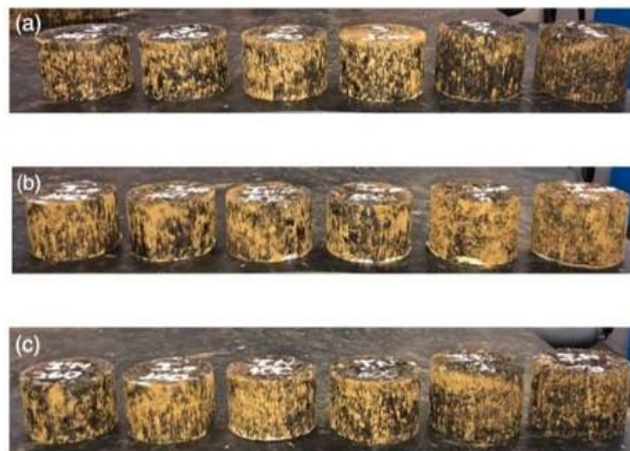
Figura 34 – Corpos de prova com substituição de 12,5% das curvas (a) Inferior, (b) intermediária e (c) superior
