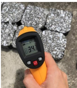
Figura 51 - Medição da temperatura superficial com a utilização do termômetro laser digital infravermelho
