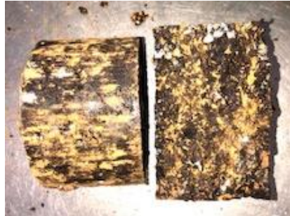
Figura 41 – Ruptura do corpo de prova no ensaio de RT
