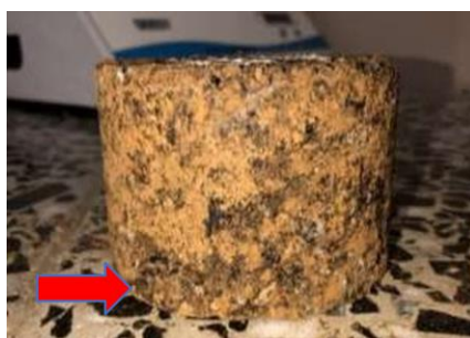
Figura 27 – Corpo de prova com 15% de rejeito e confeccionado com 8 giros
