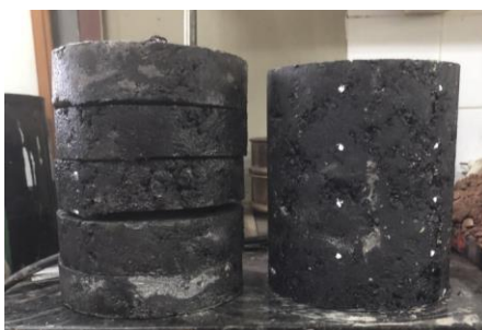
Figura 48 - Corpos de prova seccionados em círculos com 150mm
