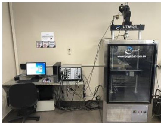
Figura 42 – Prensa UTM – 25 utilizada no ensaio de MR
