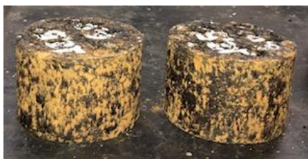
Figura 37 – Corpos de prova com 12,5% de rejeito de minério de ferro compactados com teor ótimo de 6,0%
