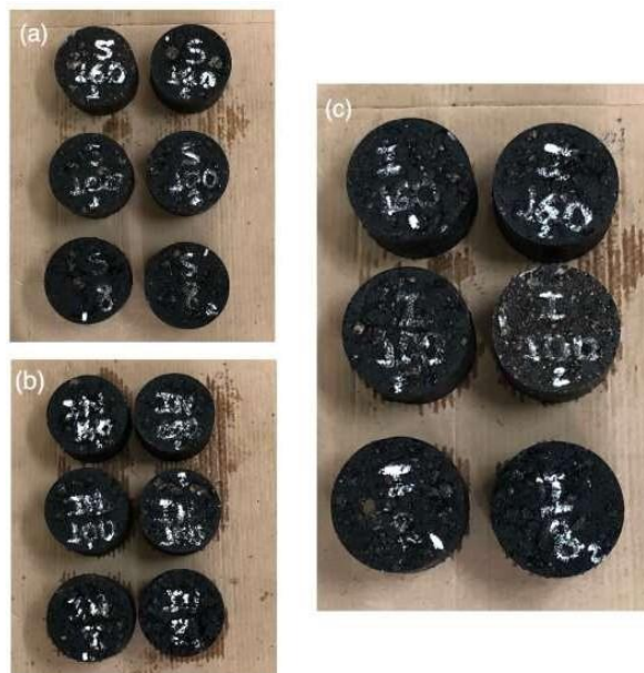
Figura 33 – Corpos de prova com substituição de 7,5% das curvas (a) Inferior, (b) intermediária e (c) superior
