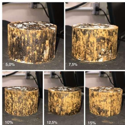
Figura 24 – Teste realizado com as porcentagens de 5%, 7,5%, 10%, 12,5% e 15% de rejeito
