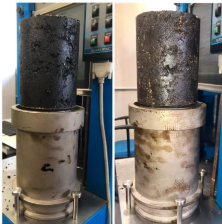
Figura 47 - Compactação dos corpos de prova com metodologia SUPERPAVE
