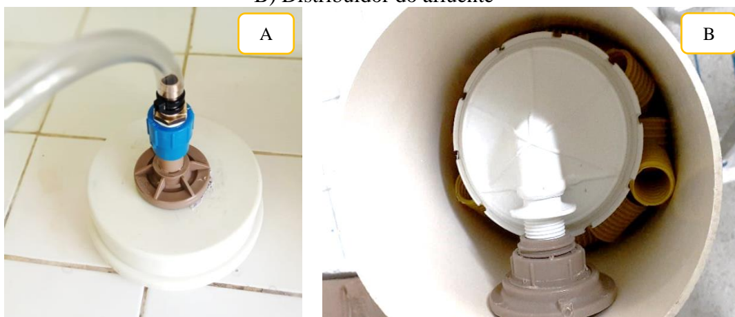
Figura 27 – Extremidade superior da torre: A) Conexões para o recolhimento do gás amônia; B) Distribuidor do afluente
