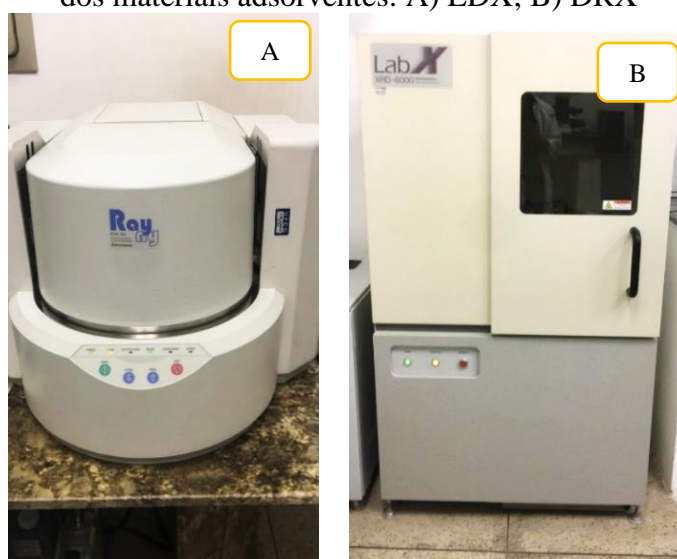
Figura 16 – Equipamentos usados para determinar as composições química e mineralógica dos materiais adsorventes: A) EDX; B) DRX
