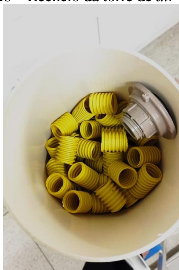
Figura 26 – Recheio da torre de air stripping
