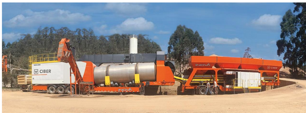
Figura 1 - Usina de asfalto Drum Mix
