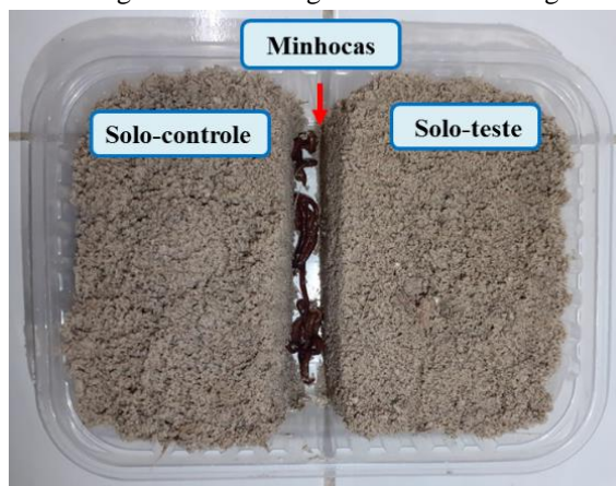
Figura 39 - Montagem do Ensaio de fuga
