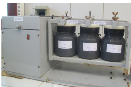
Figura 18 - Agitador rotatório para testes de lixiviação
