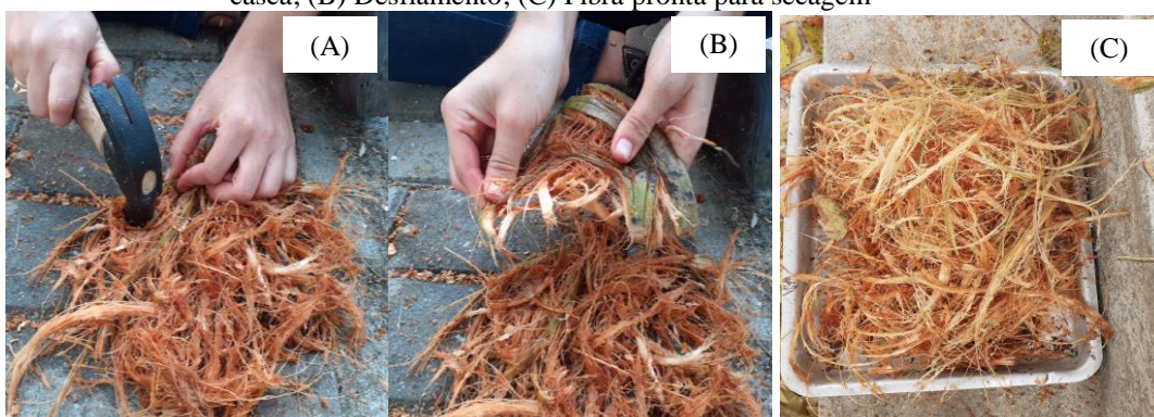
Figura 23 - Sequência das etapas para a obtenção da fibra da casca do coco: (A) Redução do tamanho da casca; (B) Desfiamento; (C) Fibra pronta para secagem
