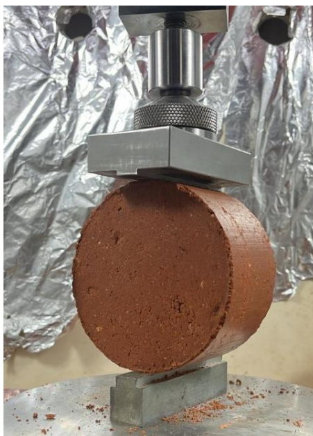
Figura 32: Ensaio de fadiga por compressão diametral.
