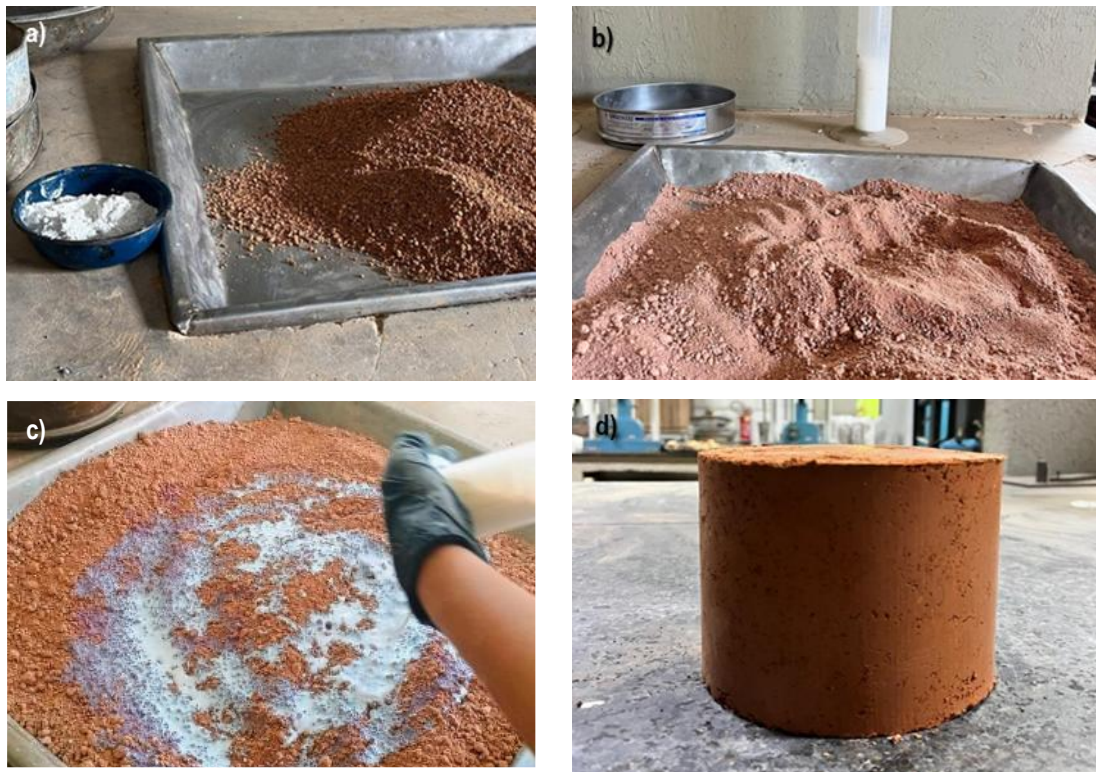
Figura 27: Processo de preparo de mistura para compactação de solo.
