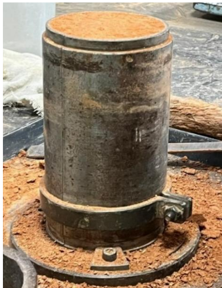
Figura 28: Cilindro de moldagem de corpo de prova para ensaios mecânicos.
