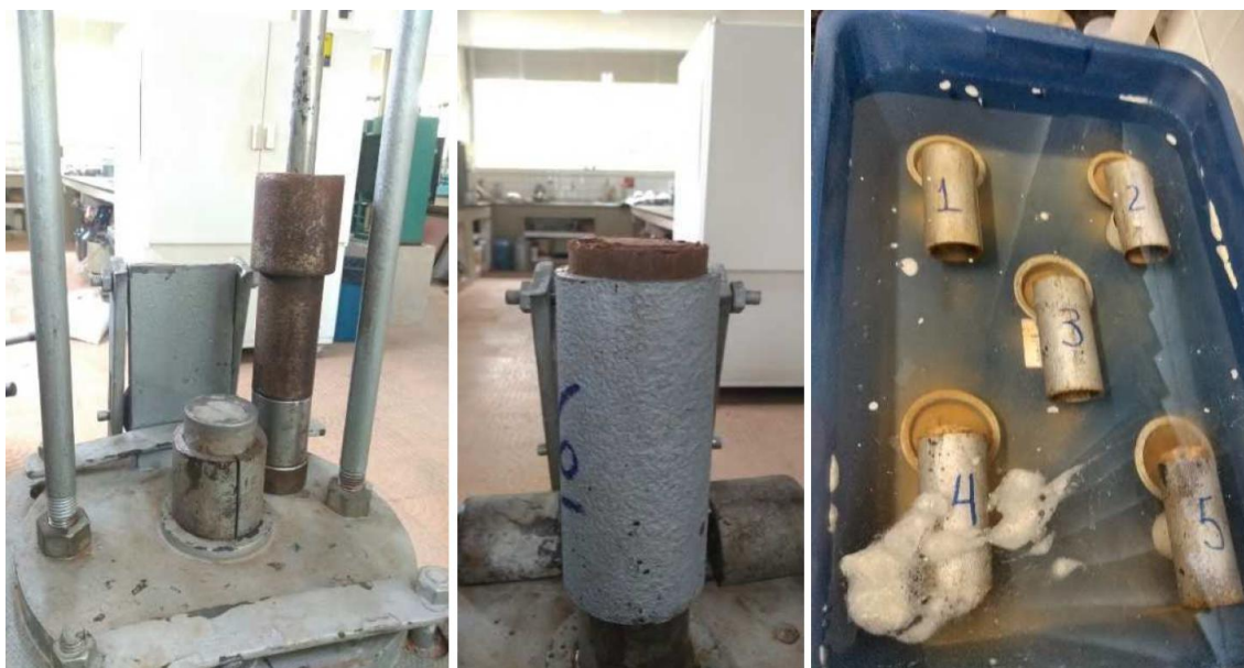
Figura 20: Ensaio para a classificação MCT e G-MCT.
