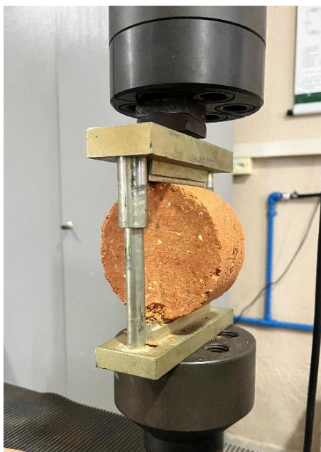
Figura 31: Aparato diametral para ensaio de RT.
