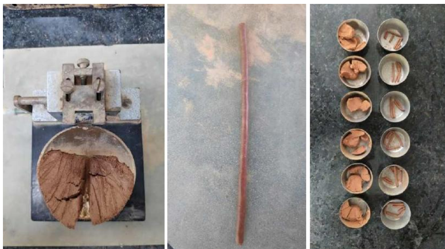
Figura 19: Ensaio de limite de liquidez e de plasticidade, respectivamente.
