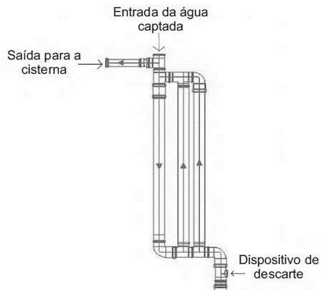
Figura 6 - Dispositivo de descarte das primeiras águas
