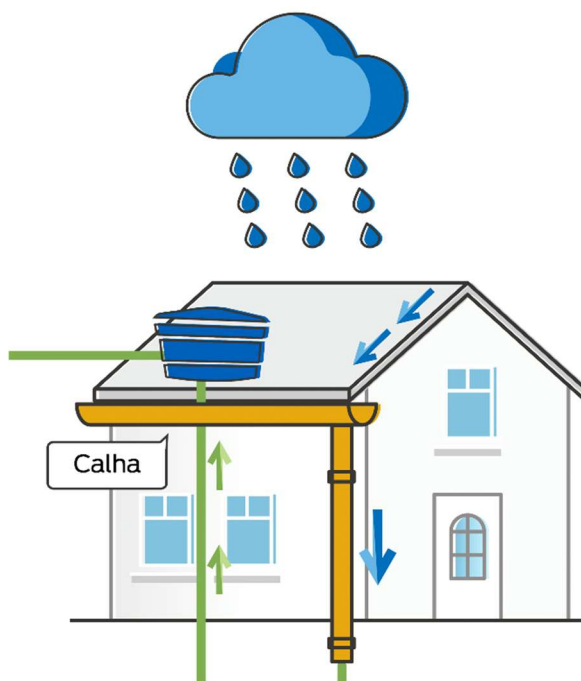
Figura 2 - Área de Captação do SAAC
