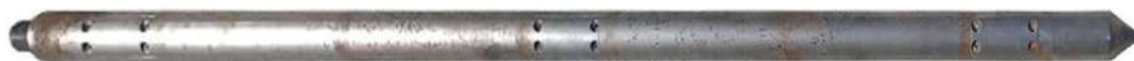
Figura 54: Ponteira utilizada, onde se observa a posição dos três geofones, numa versão atualizada daquela proposta por Vitali (2011).
