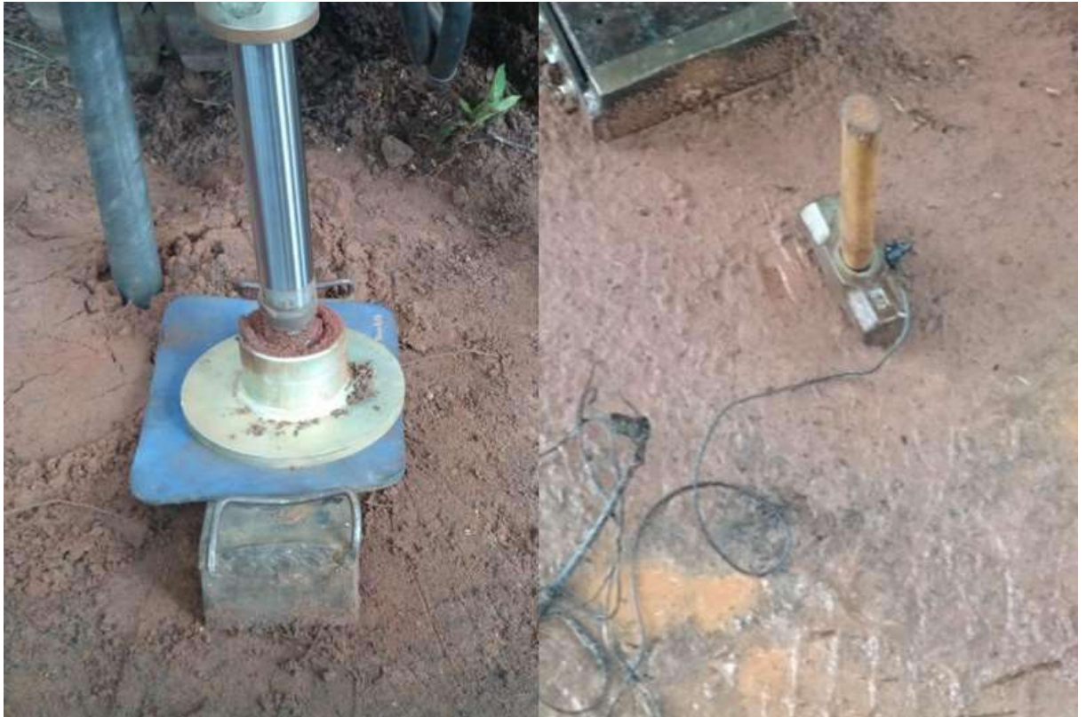
Figura 55: A fonte sísmica composta de barra de aço (a esquerda) e martelo (a direita) posicionada a frente do equipamento de cravação. Solo (2022).
