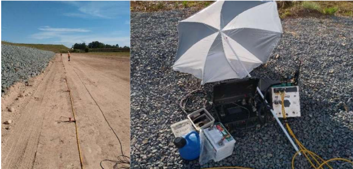
Figura 51: Disposição de arranjo e equipamento utilizado para armazenamento de dados em campo - MASW. Fugro (2023).
