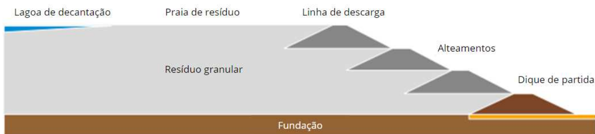
Figura 2. 7: Alateamento por montante.
