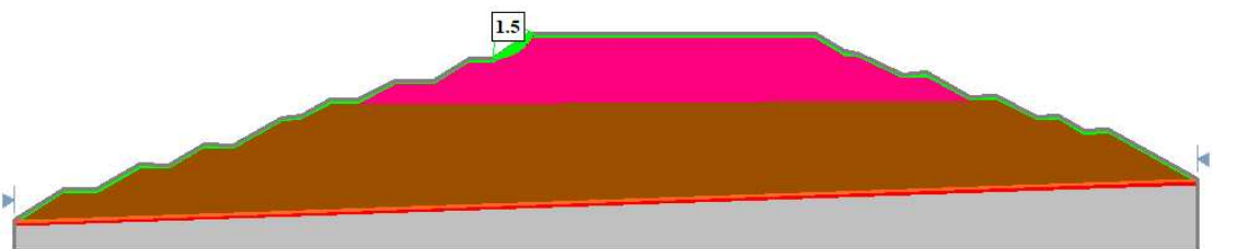
Figura 39 - Fator de segurança da Seção C – X (Corte CD) para o Cenário 1 - software slide2
