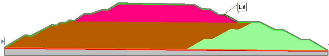
Figura 37 - Fator de segurança da Seção B – X (Corte AB) para o Cenário 1 - software slide2
