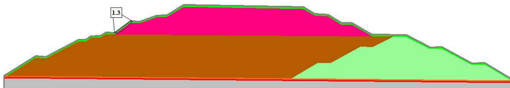
Figura 35 - Fator de segurança da Seção A – X (Corte AB) para o Cenário 1 - software slide2
