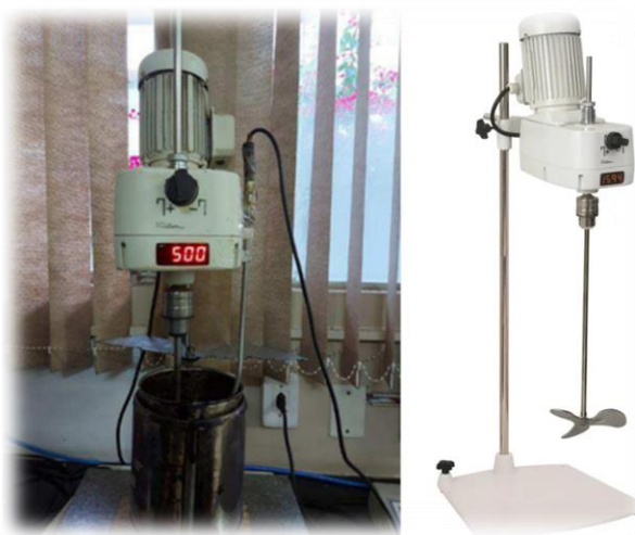
Figura 24 – Agitador mecânico utilizado para realização da modificação dos ligantes
