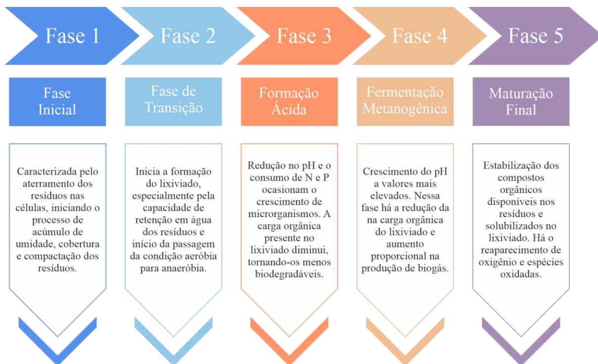
Figura 2: Fases da biodegradação dos resíduos sólidos em aterro sanitário
