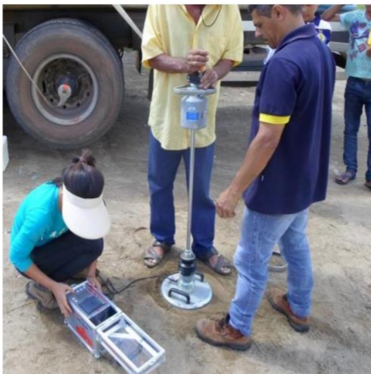
Figura 4 - Execução do ensaio com Light Weight Deflectometer (LWD)
