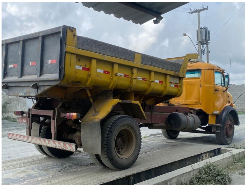
Figura 21 - Pesagem de caminhão calibrado com 8,2 tf de carga
