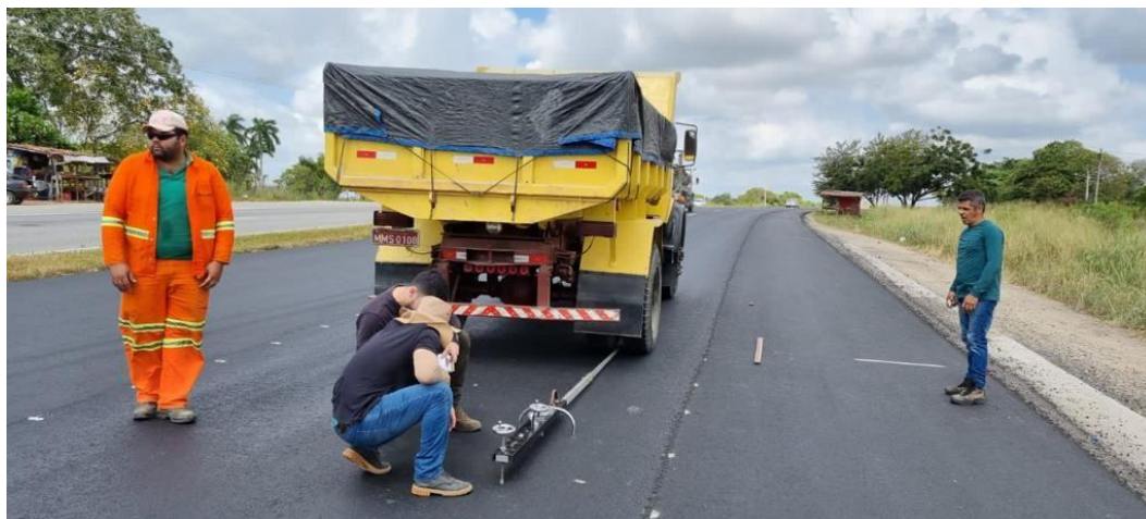
Figura 22 - Posição da viga Benkelman durante levantamento deflectométrico
