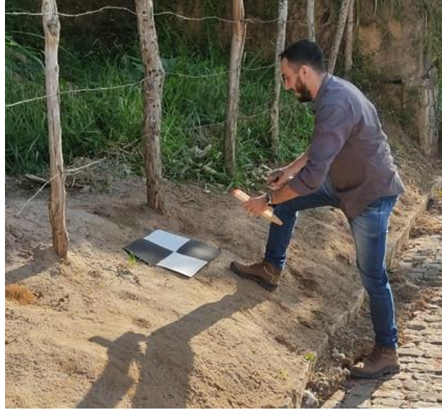
Figura 15 - Demarcação dos pontos de controle.
