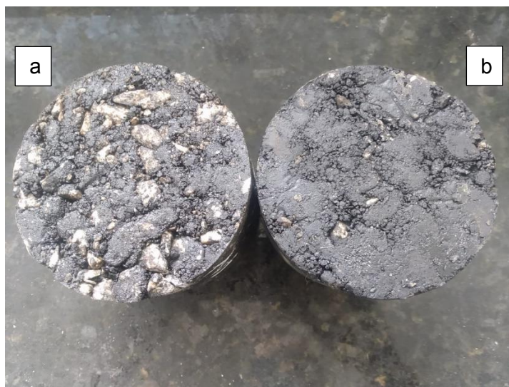
Figura 11 – Mistura asfáltica CAP 50/70 antes (a) e após aplicação do dope no ligante asfáltico (b)
