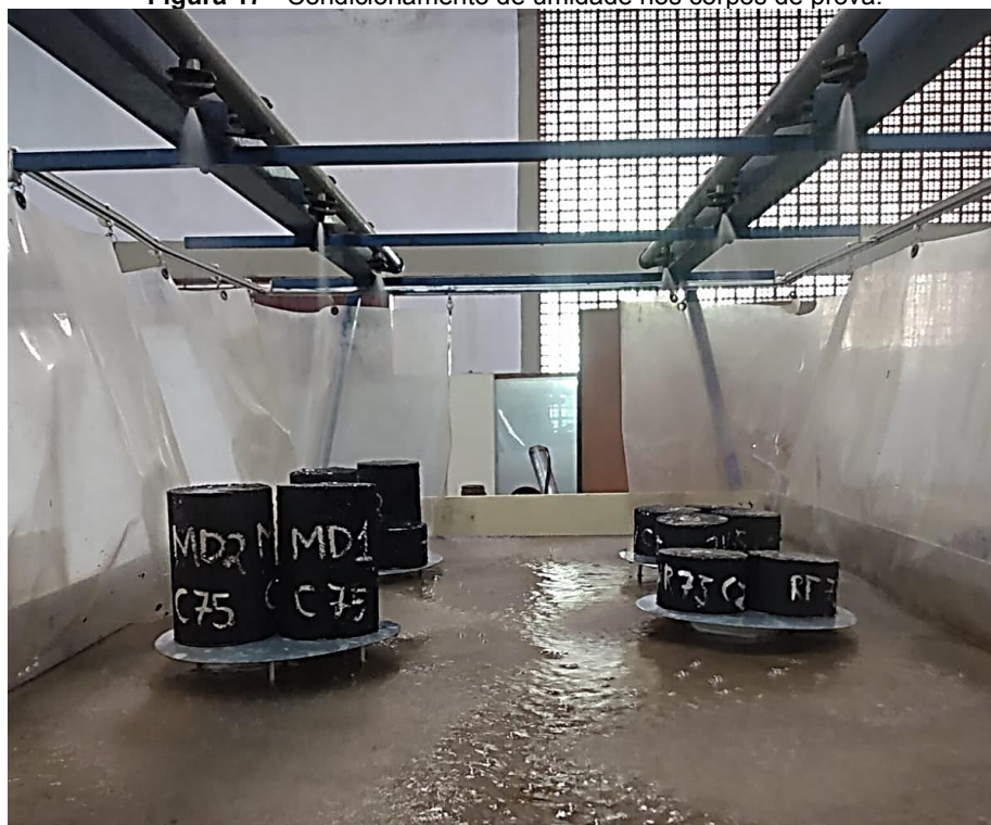
Figura 17 - Condicionamento de umidade nos corpos de prova.
