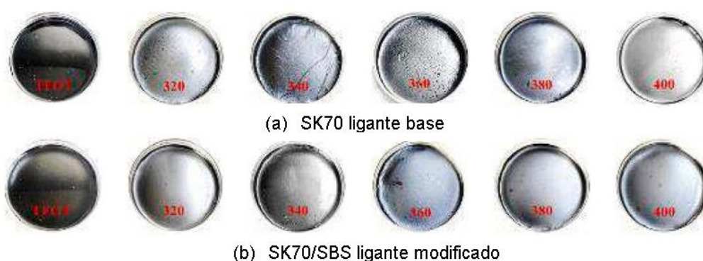
Figura 7 - Evolução do envelhecimento por UV a diferentes espectros de radiação
