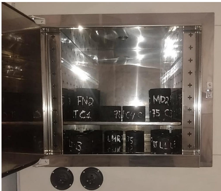
Figura 15 - Corpos de prova em estufa a 95°C por 9 dias para simulação do envelhecimento
