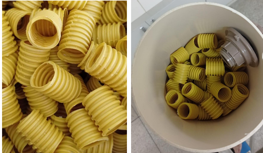
Figura 8a - Material de enchimento da torre e Figura 8b - Vista superior da torre
