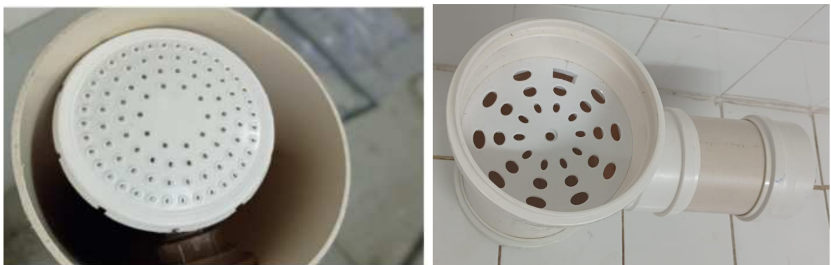
Figura 9a - Ducha para distribuição do afluente e Figura 9b - Tê de conexão com fundo falso
