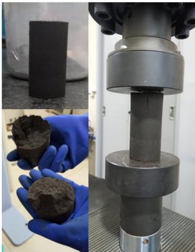
Figura 14: Etapas do ensaio de compressão simples
