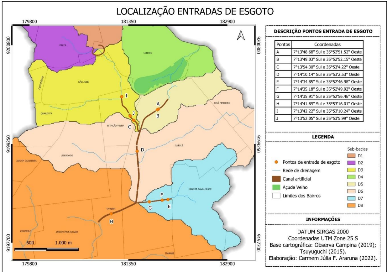
Figura 18. Localização dos pontos de entrada de esgoto ao longo da extensão revestida do canal do Prado.
