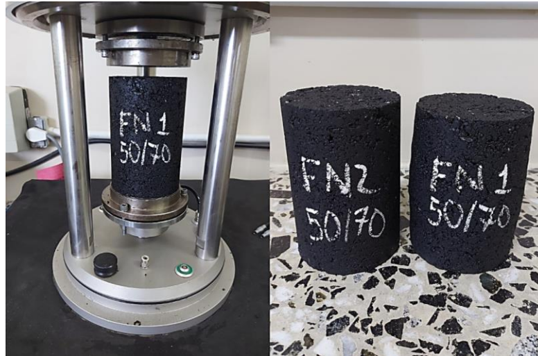
Figura 40 - Corpo de prova posicionado para início do ensaio (esquerda) e corpos de prova antes e após a realização do ensaio (direita)
