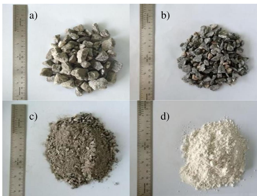
Figura 34 - Agregados e filer utilizados nesta pesquisa a) Brita 19mm; b) Brita 12,5mm; c) Pó de pedra; d) Cal
