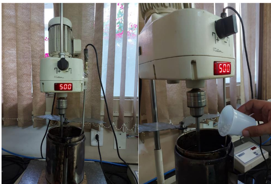
Figura 33 - Mistura dos polímeros e ácido com agitador mecânico
