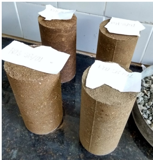
Figura 27 – Corpos de prova do ensaio de M_R submetidos à secagem ao ar
