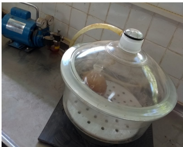
Figura 26 – Picnômetro submetido a vácuo de 88kPa
