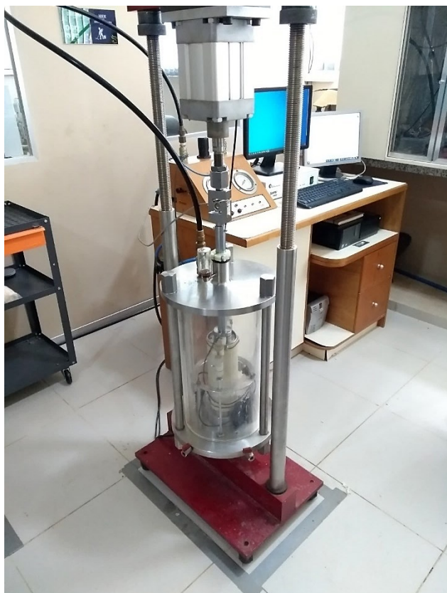
Figura 29 – Prensa triaxial dinâmica do LEP-UFCG durante a realização do ensaio de M_R
