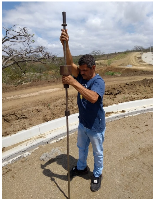
Figura 20 – Execução do ensaio de CPD
