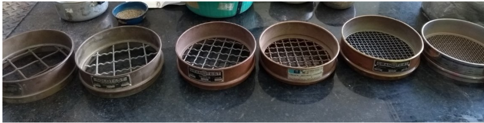
a) Da esquerda para direita: peneiras de 50mm, 38mm, 25mm, 19mm, 9,5mm e 4,8mm
