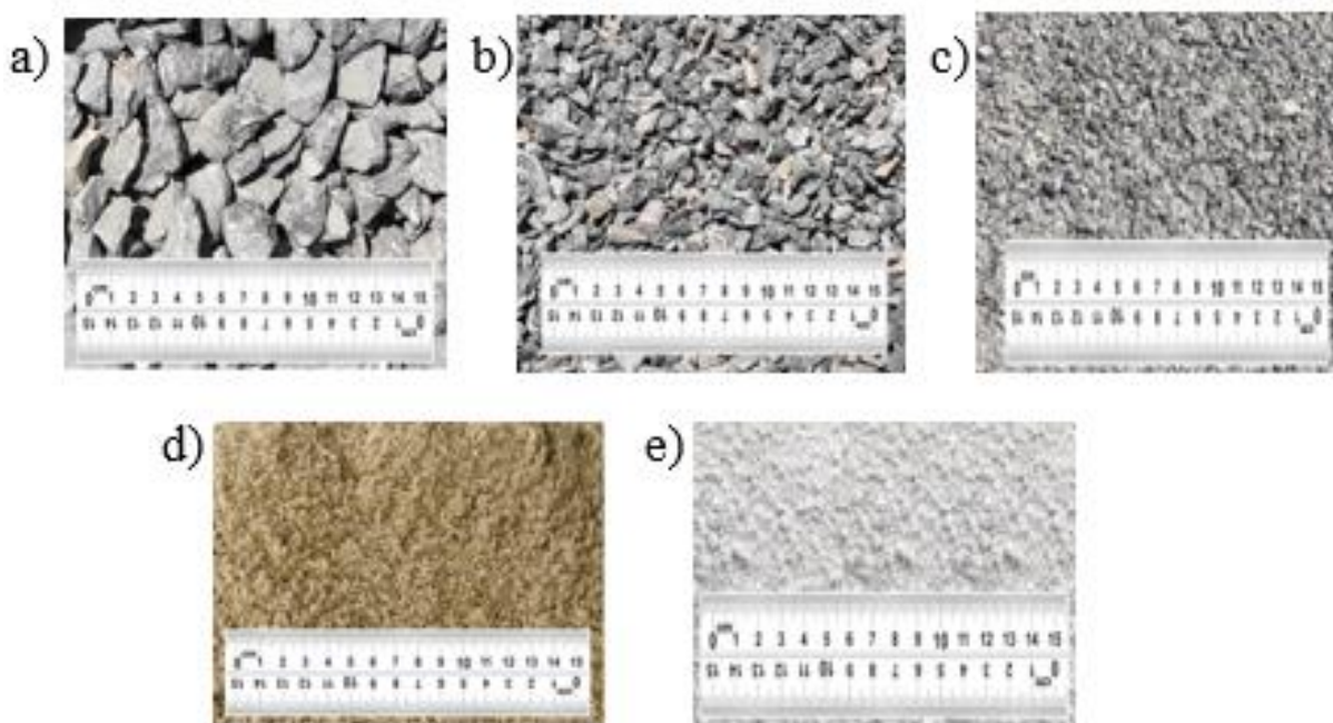
Figura 29. Agregados utilizados nesta pesquisa: (a) Brita 19 mm; (b) Brita 12,5 mm; (c) Pó de Pedra; (c) Areia e (d) Cal hidratada.
