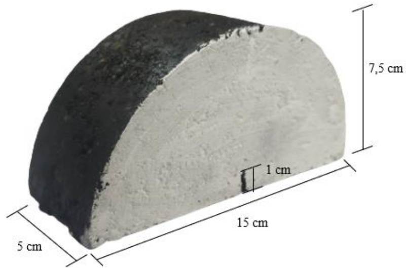
Figura 43. Geometria do corpo de prova obtido.
