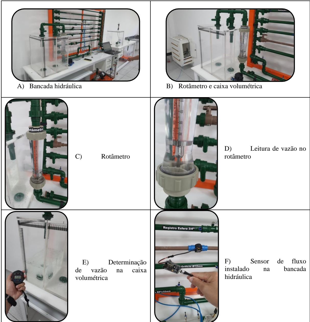
Figura 13 - Bancada hidráulica usada para fazer a calibração com altas vazões
