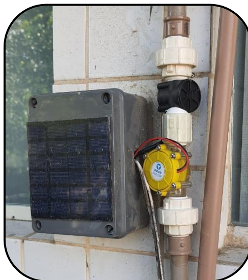
Figura 34 - Medidor de fluxo de paredes transparentes em série com o sensor de fluxo utilizado
