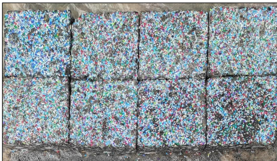
Figura 48 – Placa 3 para medir a refletância e temperatura superficial, fabricado com ligante do tipo AMP 55/75 e colorida com PEAD na superfície.
