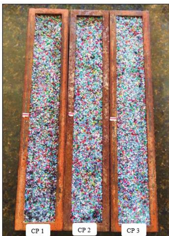
Figura 41 – CPs antes do procedimento de afundamento e desgaste
