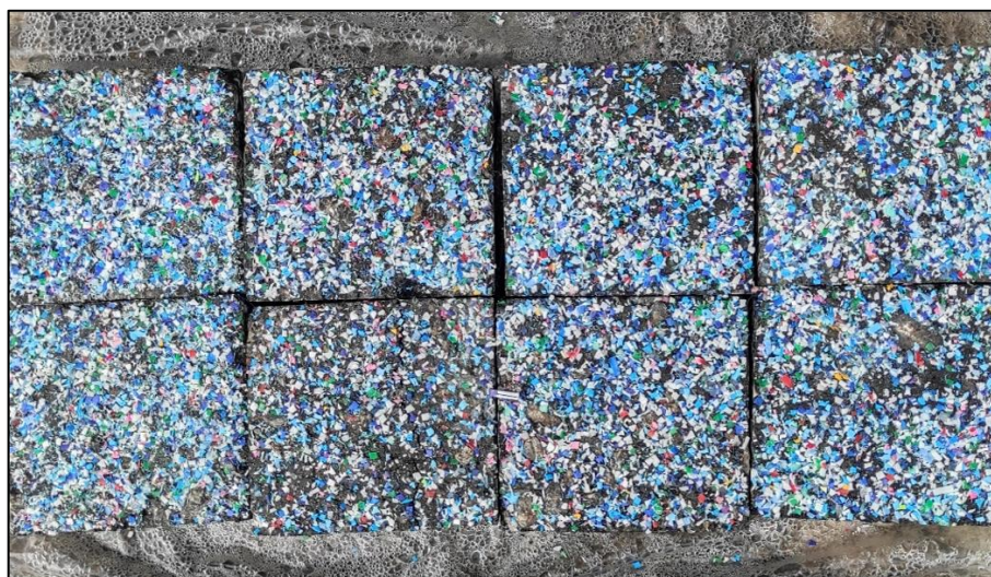
Figura 47 – Placa 2 fabricado com ligante modificado e colorida com PEAD na superfície.
