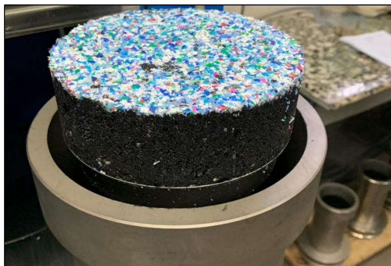
Figura 44 – Produção do CPs para a placa
