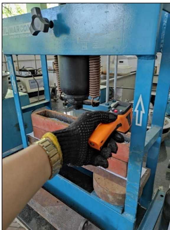
Figura 40 – Processo de compactação do corpo de prova de LWT.
