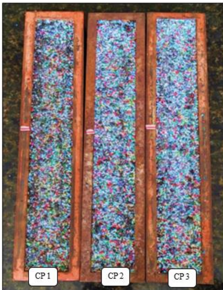
Figura 62 – CPs de desgaste, respectivamente, cap 50/70, cap 50/70 modificado com PEAD e AMP 55/75.
