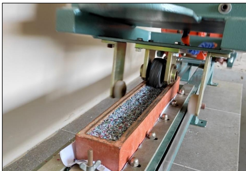
Figura 42 – Execução do ensaio de LWT
