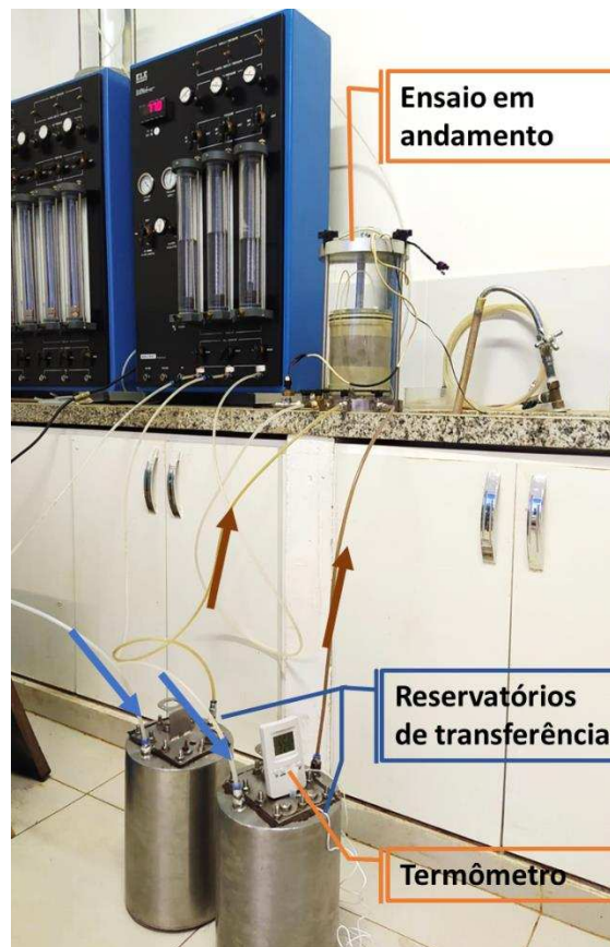
Figura 14. Esquema do procedimento de saturação das amostras com lixiviado.
