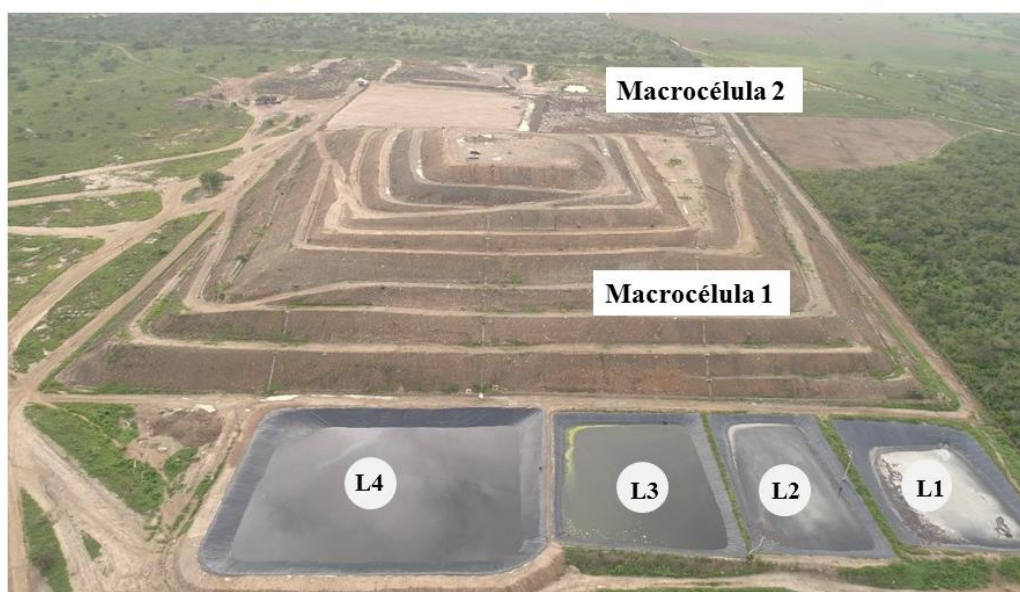
Figura 2 - Células do ASCG e as lagoas de acúmulo e evaporação de lixiviado
