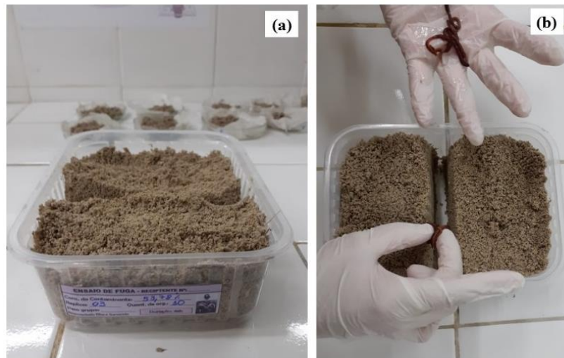
Figura 19 - Recipiente-teste do ensaio de fuga (a) e Colocação dos organismos no recipiente-teste (b)
