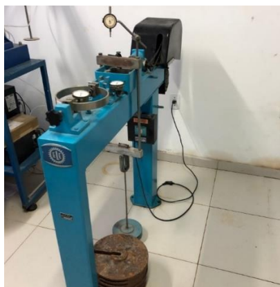
Figura 25: Prensa de cisalhamento direto utilizada na pesquisa.
