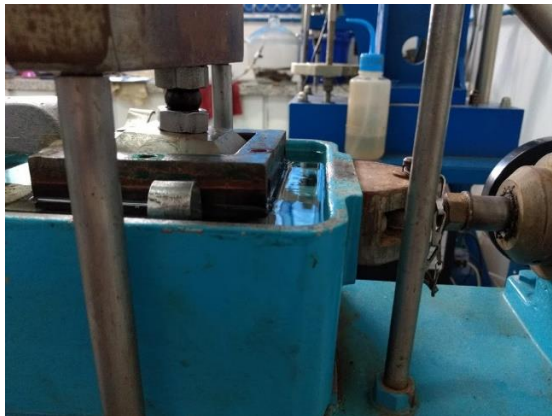
Figura 27: Caixa bipartida imersa em ácido acético.
