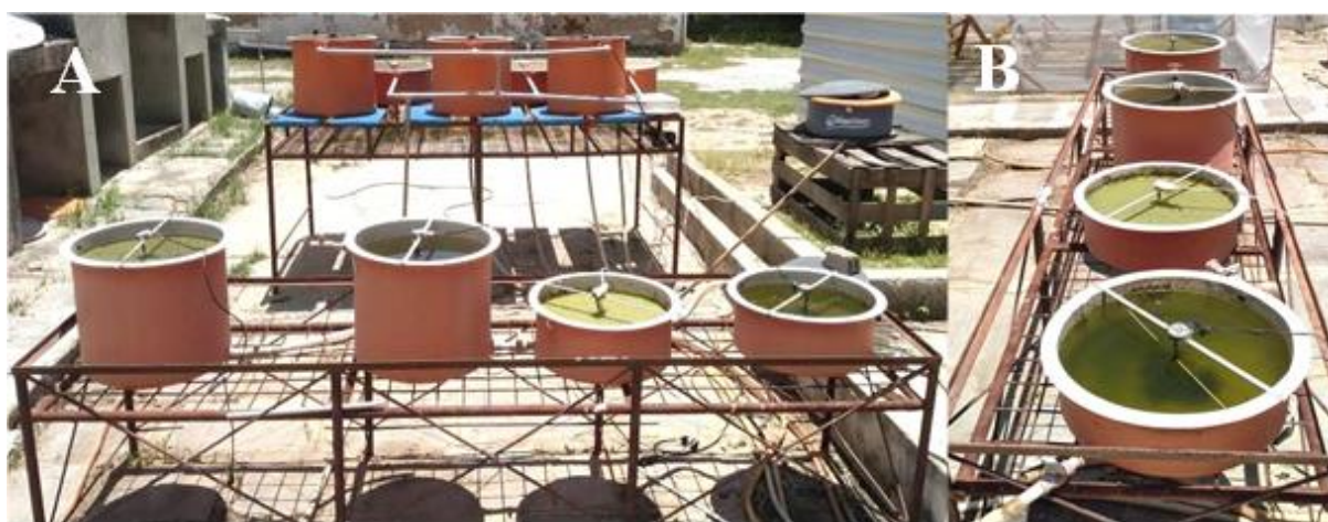
Figura 5 - (A) Detalhe da palheta giratória da mistura da lagoa. (B) LPFC2 de 0,40 metros de profundidade. Fonte: Autor (2020).
