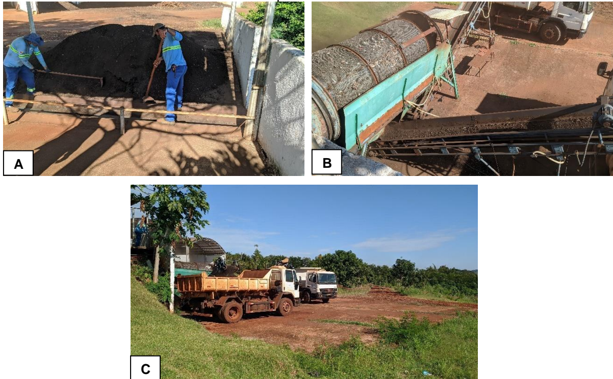
Figura 17 - Etapas de compostagem: (A) disposição do resíduo na esteira; (B) Passagem pela peneira e separação de orgânicos e rejeitos; (C) Caminhões basculantes necessários para o processo
