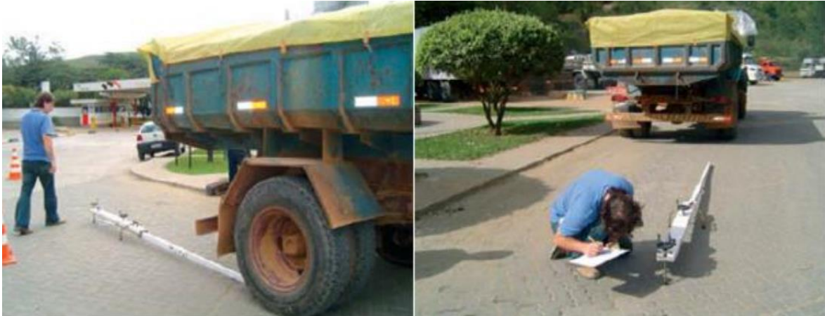
Figura 10 - Ensaio Viga Benkelman.
