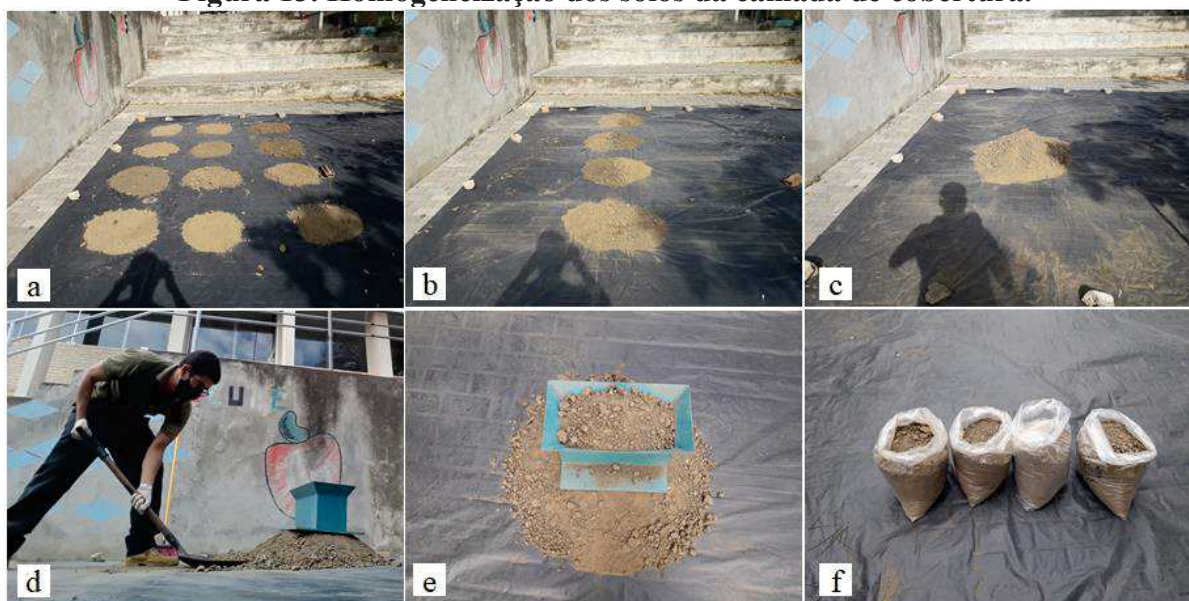
Figura 13. Homogeneização dos solos da camada de cobertura.
