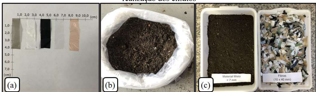
Figura 30 – (a) Fibras; (b) Material misto com dimensões < 7mm; (c) Resíduos para realização dos ensaios
