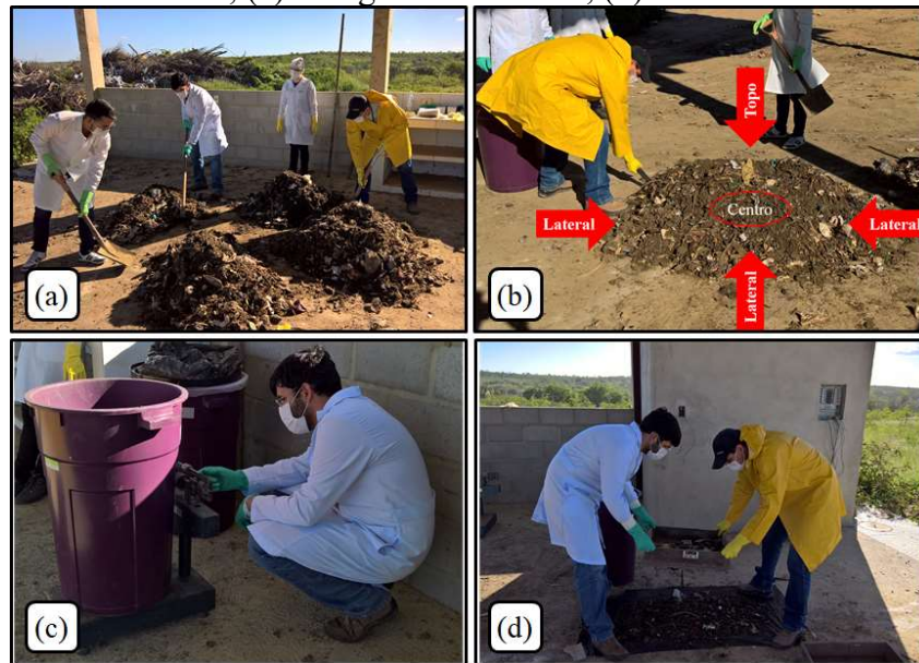
Figura 22 – (a) Quarteamento do material misto; (b) Coleta do material do topo, das laterais e do centro; (c) Pesagem do material; (d) Peneiramento
