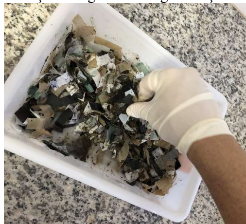
Figura 32 – Adição de água e homogeneização dos materiais
