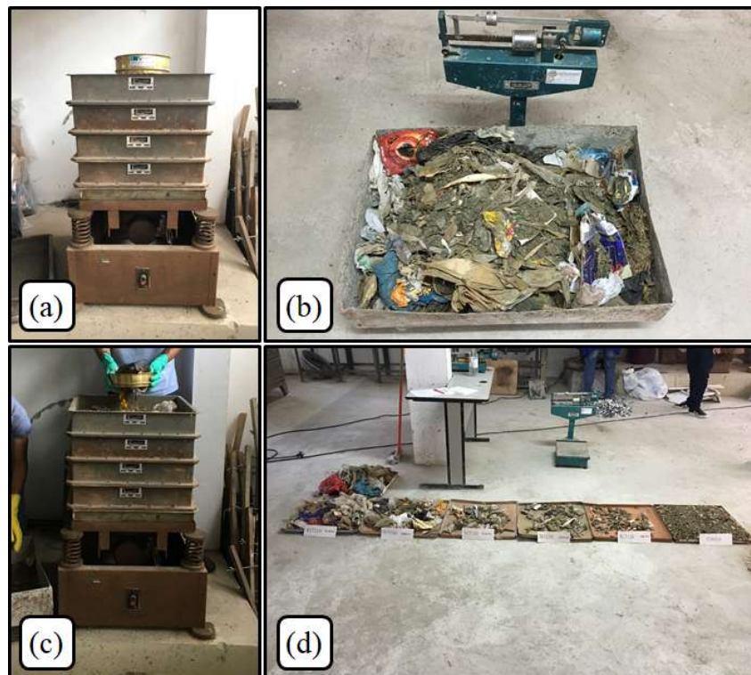
Figura 25- (a) Peneiras para o ensaio; (b) Pesagem da amostra; (c) Peneiramento; (d) Frações da amostra
