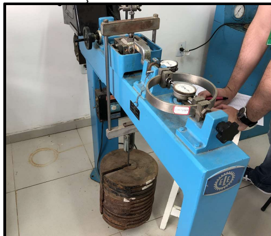
Figura 40 – Realização do ensaio de cisalhamento direto
