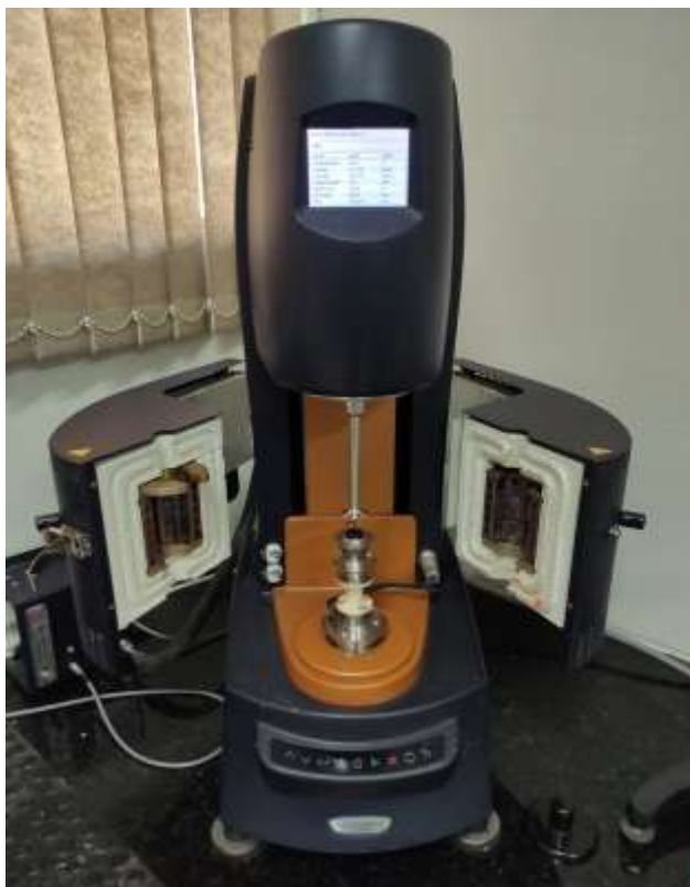
Figura 26 - Reômetro de cisalhamento direto (DSR)
