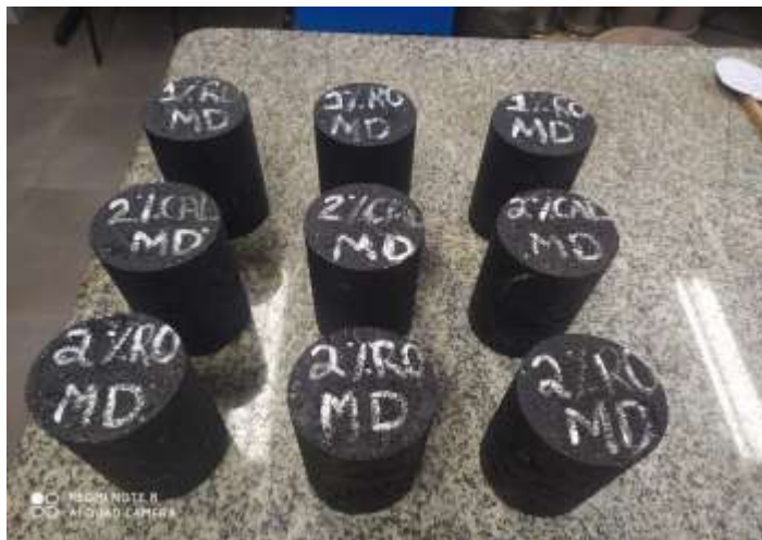
Figura 30 - Corpos de prova do ensaio de MD
