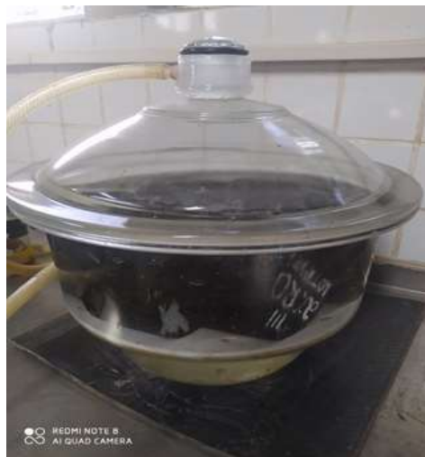
Figura 27 - CP's submetidos a pressão de vácuo
