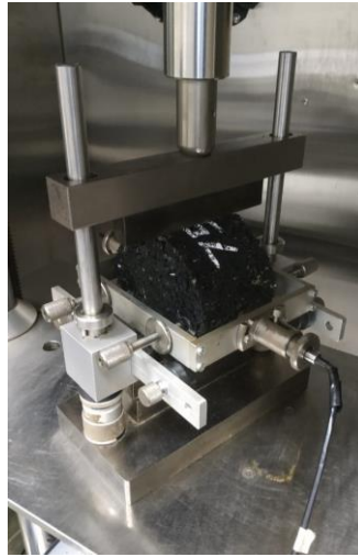
Figura 31 - corpo de prova na UTM-25 durante ensaio de Módulo de Resiliência
