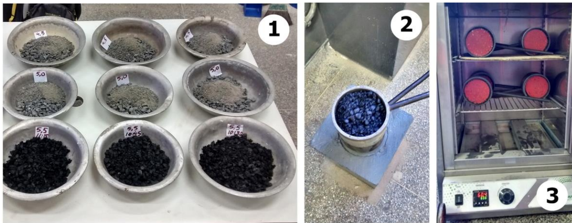
Figura 3 - Etapas da dosagem de um PMF
