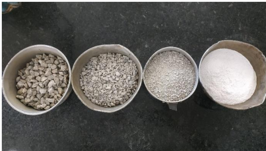
Figura 13 – Agregados graníticos utilizados na fabricação das misturas de controle
