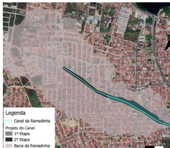
Figura 16: Etapas de execução do Canal da Ramadinha
