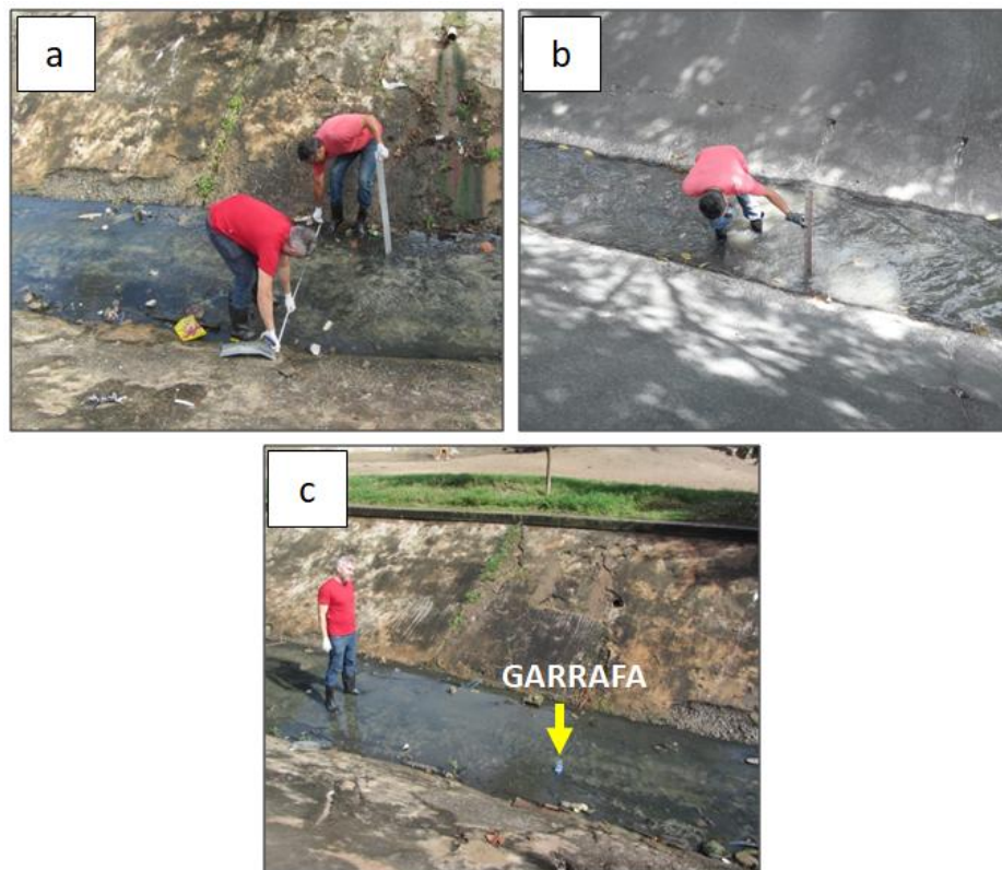
Figura 10: Etapas da medição de vazão no canal.
