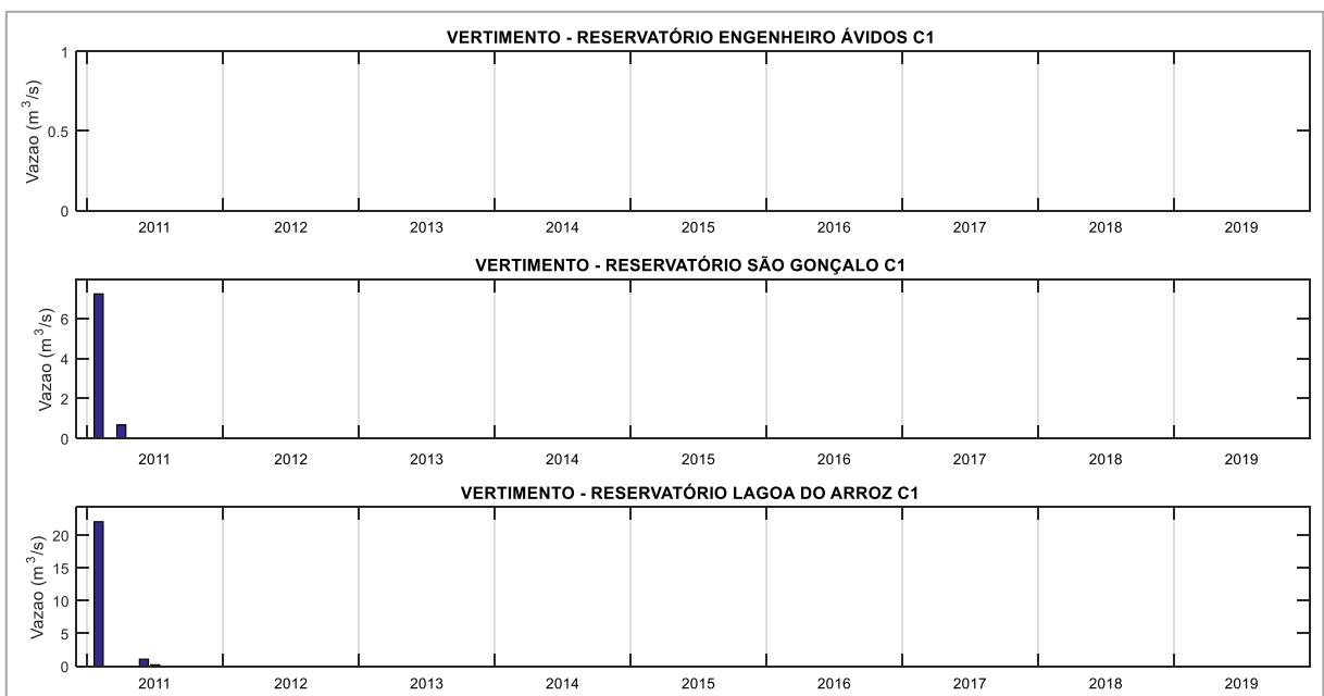
Figura 29. Vazões de vertimento nos reservatórios Engenheiro Ávidos, São Gonçalo e Lagoa do Arroz para o Cenário C1.
