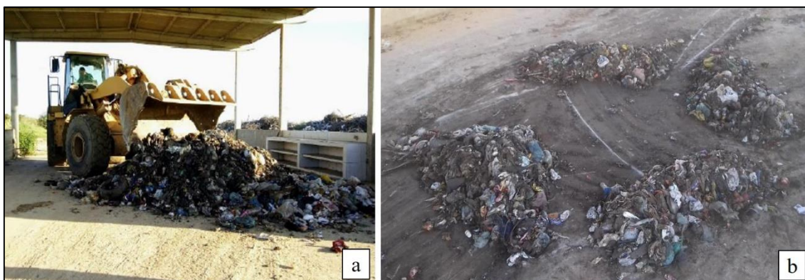
Figura 7. Homogeneização (a) e quarteamento (b) dos RSU no galpão do ASCG
