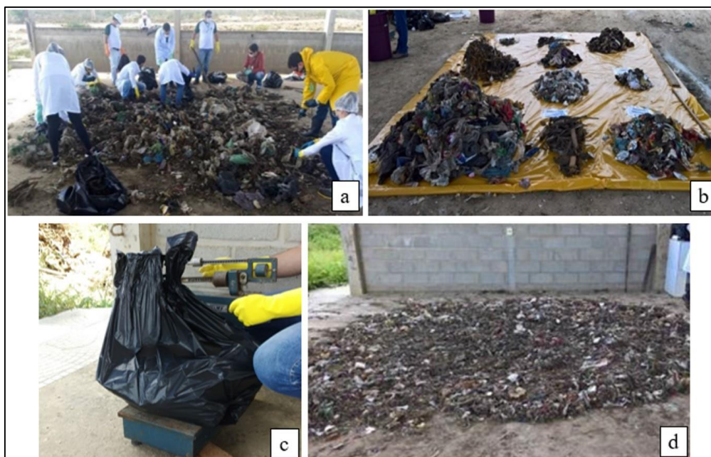
Figura 9. Segregação dos resíduos sólidos (a) em categorias (b), pesagem (c) para composição gravimétrica e material misto resultante (d)
