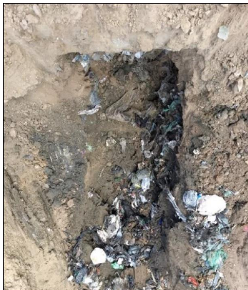
Figura 8. Célula escavada para coleta dos RSU de um ano de aterramento
