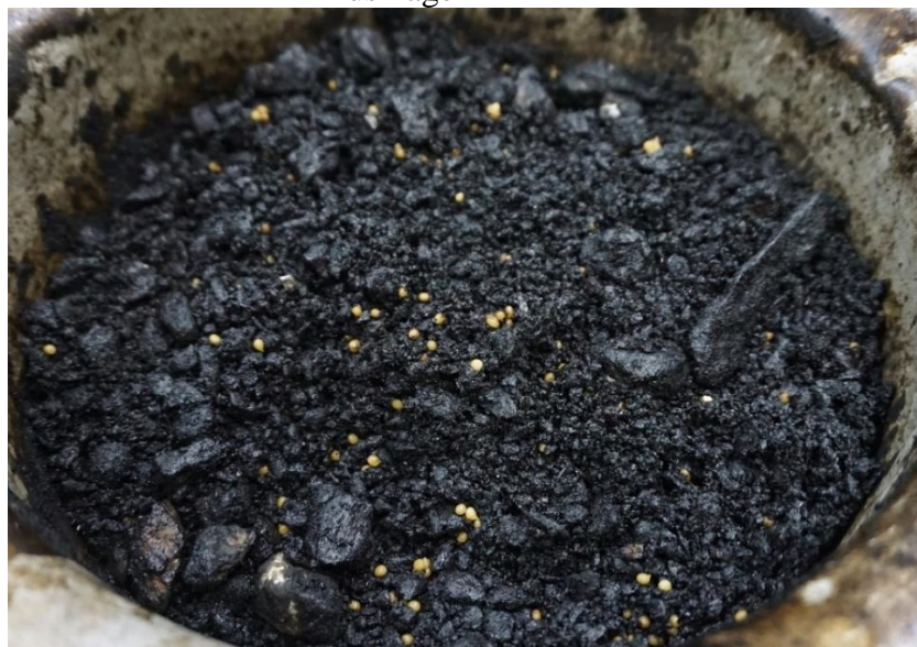
Figura 47 – Mistura asfáltica após homogeneização das cápsulas Tipo 1 residual durante a usinagem
