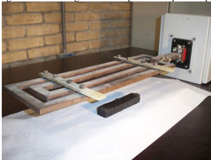
Figura 19 – Bobina geradora de aquecimento por indução
