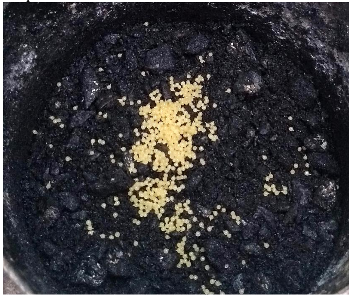
Figura 46 – Cápsulas Tipo 1 residual adicionadas na mistura asfáltica durante a usinagem
