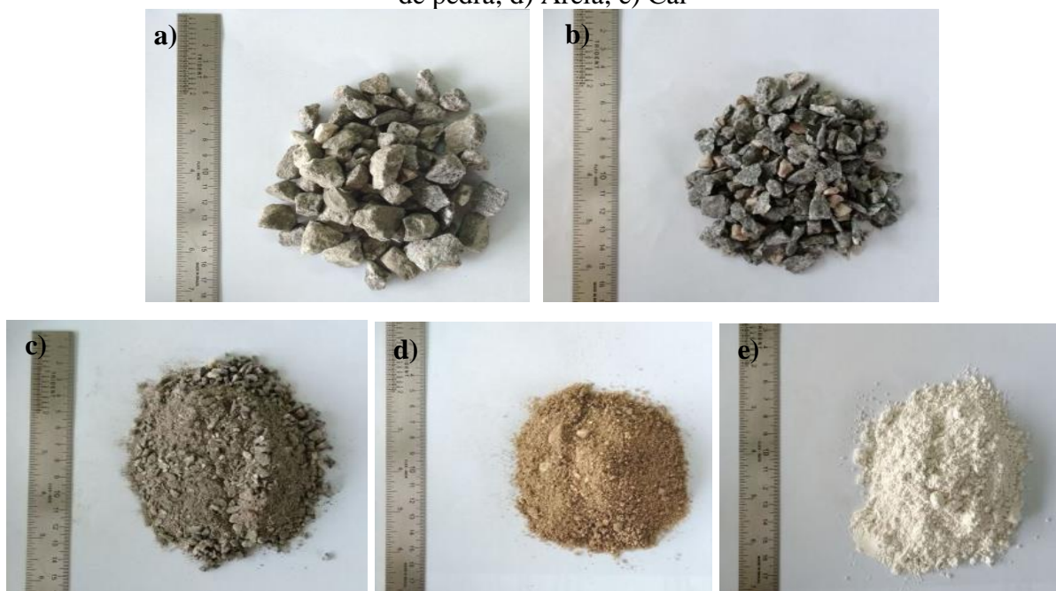
Figura 33 – Agregados e fíler usados nesta pesquisa: a) Brita 19mm; b) Brita 12,5mm; c) Pó de pedra; d) Areia; e) Cal
