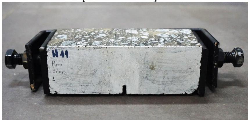
Figura 58 – Corpo de prova confinado em molde após realizado o primeiro ensaio de flexão de três pontos sobre fundação elástica
