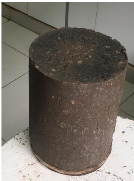
Figura 13: Corpo de prova após ensaio de permeabilidade ao lixiviado
