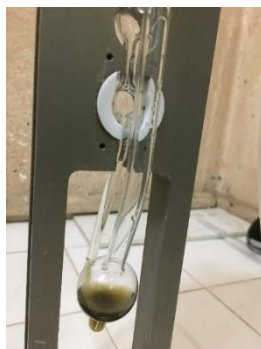
Figura 16: Tubo Capilar com lixiviado
