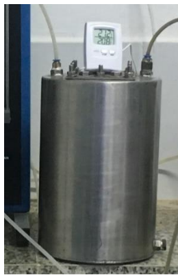
Figura 11: Reservatório em aço inox para armazenamento de lixiviado
