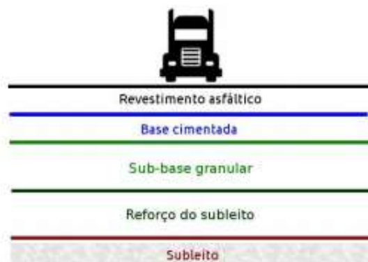
Figura 3 - Estrutura de pavimento semirrígido
