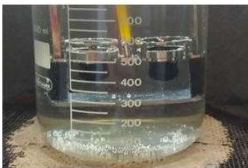
Figura 26 - Realização do ensaio de ponto de amolecimento
