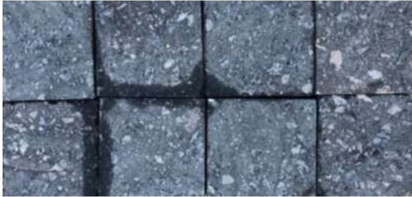
Figura 49 - Placa para medir a refletância e a temperatura superficial (cor preta)
