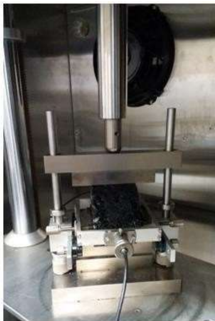
Figura 44 - Compressão diametral de corpos de prova cilíndricos
