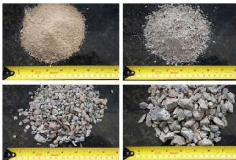
Figura 20 - Agregados: areia, pó de pedra, brita 12.5mm e brita 19mm
