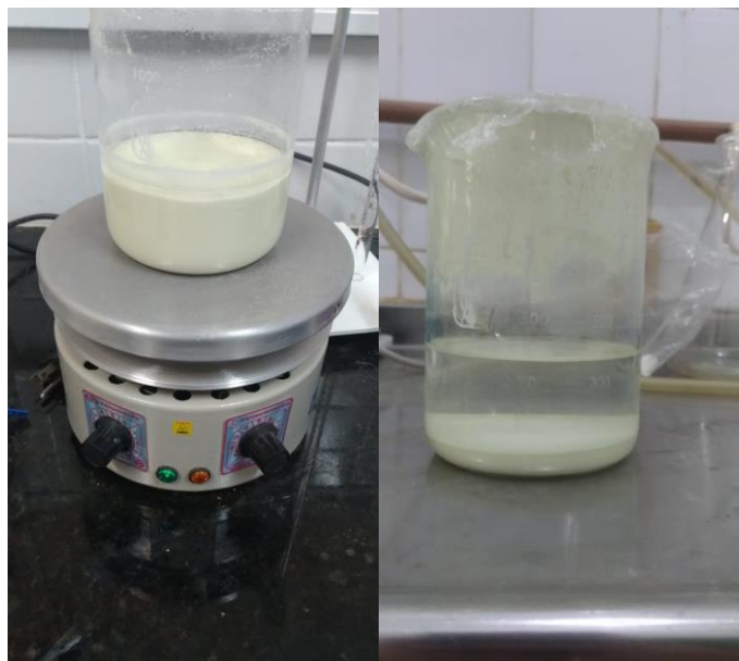
Figura 28 - Agitação da mistura após adição de GPTMS por agitador magnético e solução após 24h de agitação.
