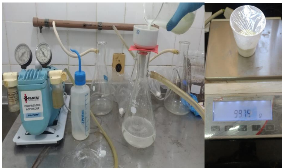
Figura 29 - Processo de filtração para retirada do excesso de GPTMS e, após secagem em estufa, obtenção das nanopartículas de ZnO M
