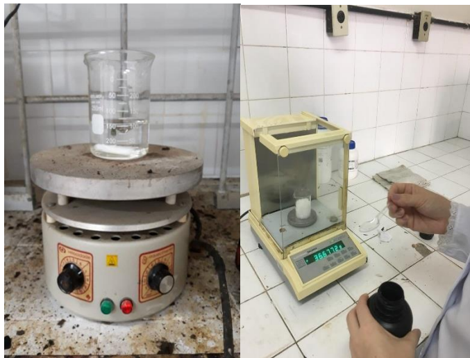
Figura 23 - Água destilada mantida sob agitação mecânica sobre placa aquecedora à 80^{\circ}\text{C} \pm 5^{\circ}\text{C} e adição de ácido cítrico anidro, nitrato de zinco e etileno glicol.
