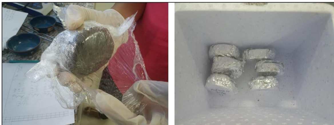
Figura 18. Amostras envolvidas com filme plástico e acondicionadas.
