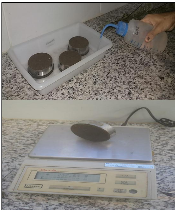
Figura 17. Amostras com lâmina d'água e pesagem após saturação.
